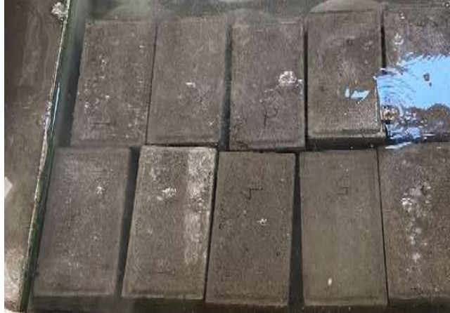
Gambar 4. 25 Pengujian Penyerapan Air
