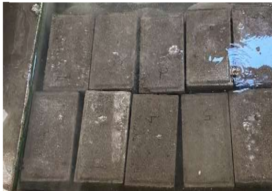
Gambar L-3. 4 Pengujian Penyerapan Air
