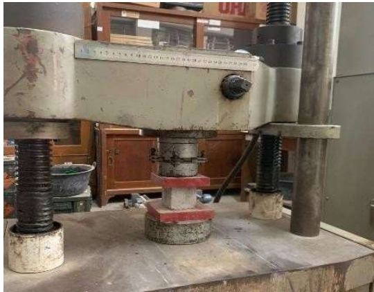
Gambar L-3. 3 Pengujian Kuat tekan
