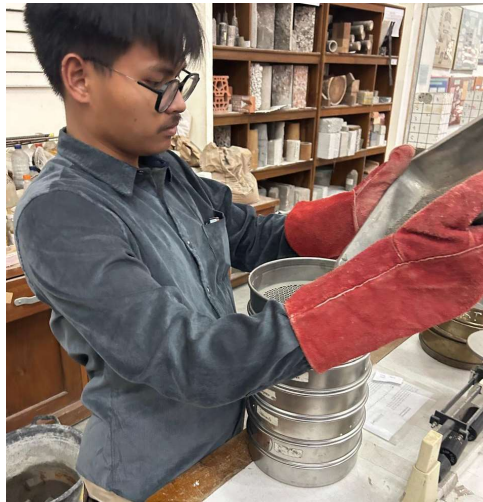
Gambar 4. 15 Pengujian Modulus Halus Butir Agregat Halus
