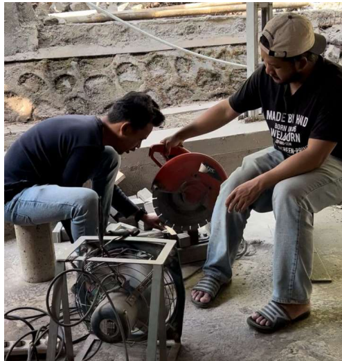
Gambar 4. 23 Proses Pemotongan Benda Uji
