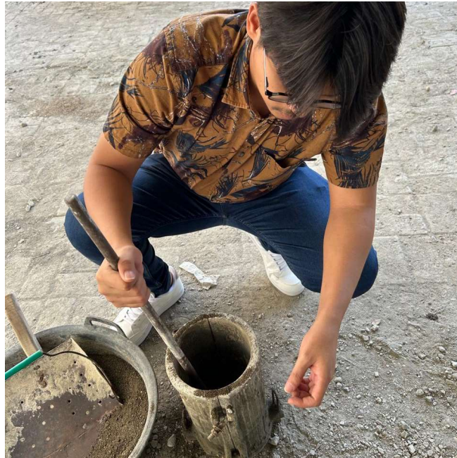
Gambar 4. 16 Pengujian Berat Volume Agregat Halus
