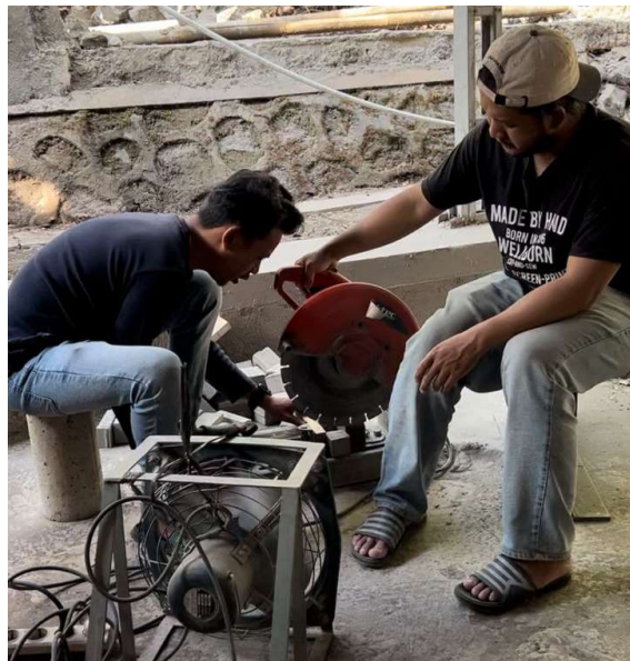
Gambar L-3. 2 Pemotongan Benda Uji
