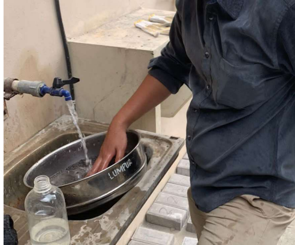
Gambar 4. 19 Pengujian kandungan Lumpur Abu Batu
