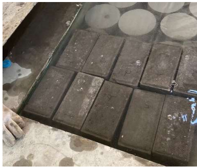
Gambar 3. 4 Proses Perawatan Benda Uji
