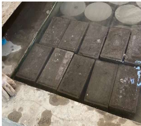
Gambar 4. 22 Proses Perawatan Benda Uji
