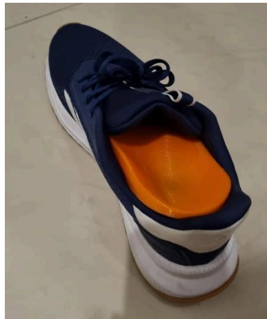
Gambar 4.25 Kegagalan Insole iterasi Desain 2
