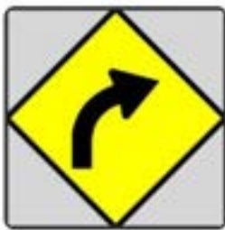
Tikungan atau belokan ke kanan
