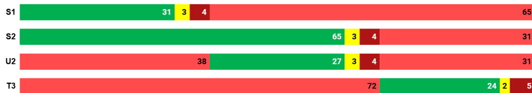
Gambar 5.3 Diagram Waktu Isyarat Simpang Borobudur Plaza
