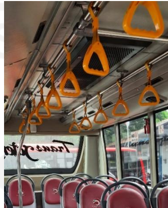
Gambar 5. 24 Fasilitas Pegangan untuk Penumpang Berdiri
