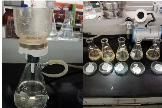
Gambar 3. 8. Sampel setelah Sentrifugasi dan disaring pada Kertas Saring
