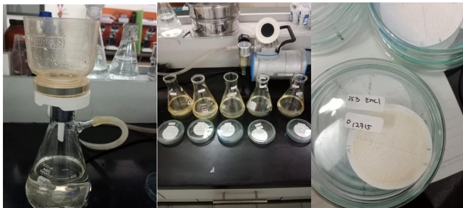
Lampiran 6. Proses Penyaringan Pada Kertas Saring
