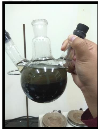
Hasil refluks dan filtrasi abu daun bambu
