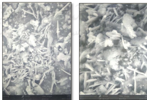
Gambar 13. SEM \text{Fe}_3\text{O}_4@\text{SiO}_2 20% perbesaran 5.000x (kiri) dan 10.000x (kanan)
