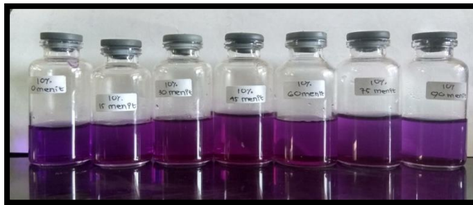
Hasil uji fotodegradasi metil violet dengan fotokatalis \text{Fe}_3\text{O}_4@\text{SiO}_2 10% pada variasi waktu 0,15,30,45,60,75,90 menit (kiri ke kanan)
