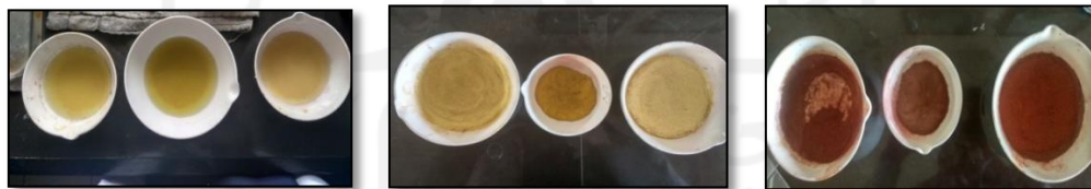
Gambar 11. a) larutan komposit Fe 3 O 4 @SiO 2 , b) komposit Fe 3 O 4 @SiO 2 setelah dioven, c) komposit setelah di kalsinasi
