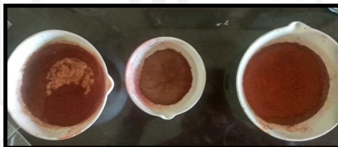
Komposit fotokatalis \text{Fe}_3\text{O}_4@\text{SiO}_2 setelah dikalsinasi
