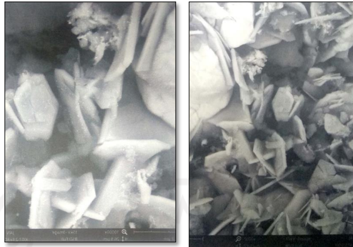
Gambar 14. SEM \text{Fe}_3\text{O}_4@\text{SiO}_2 40% perbesaran 5.000x (kiri) dan 10.000x (kanan)
