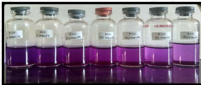
Hasil uji fotodegradasi metil violet dengan fotokatalis \text{Fe}_3\text{O}_4@\text{SiO}_2 20% pada variasi waktu 0,15,30,45,60,75,90 menit (kiri ke kanan)
