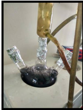
Proses refluks abu daun bambu dengan NaOH
