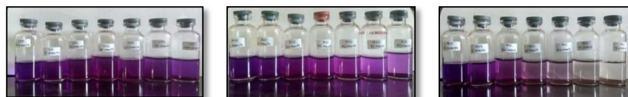
Gambar 22. Perubahan warna larutan metil violet setelah fotodegradasi secara berurutan variasi 10% ; 20% ; 40%.
