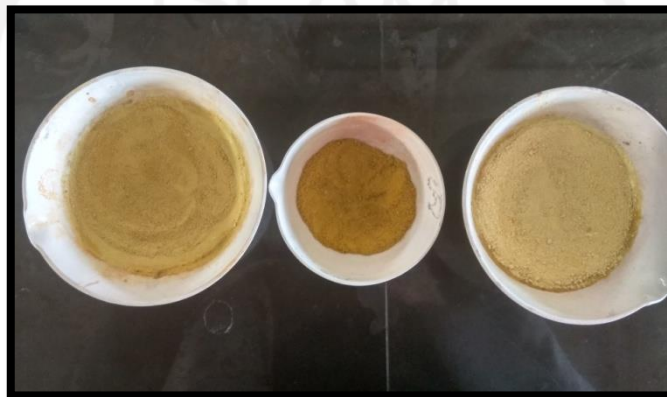
Hasil imobilisasi \text{Fe}_3\text{O}_4@\text{SiO}_2 dengan refluks sesudah filtrasi
