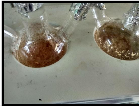
Proses imobilisasi \text{Fe}_3\text{O}_4@\text{SiO}_2 dengan metode refluks
