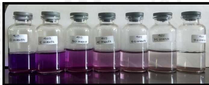
Hasil uji fotodegradasi metil violet dengan fotokatalis \text{Fe}_3\text{O}_4@\text{SiO}_2 40% pada variasi waktu 0,15,30,45,60,75,90 menit (kiri ke kanan)
