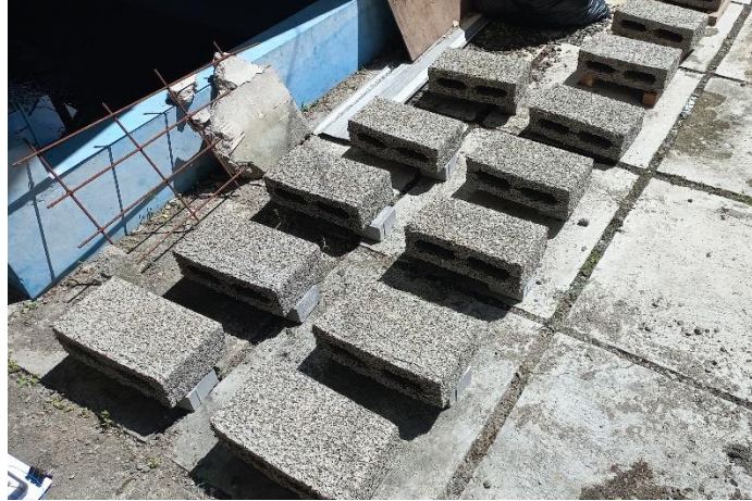
Gambar L-4.1 Proses Penjemuran Batako
