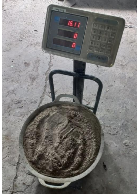
Gambar L-1.1 Penimbangan Bahan Campuran Batako
