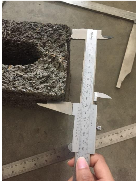
Gambar L-2.1 Pengukuran Dimensi Batako
