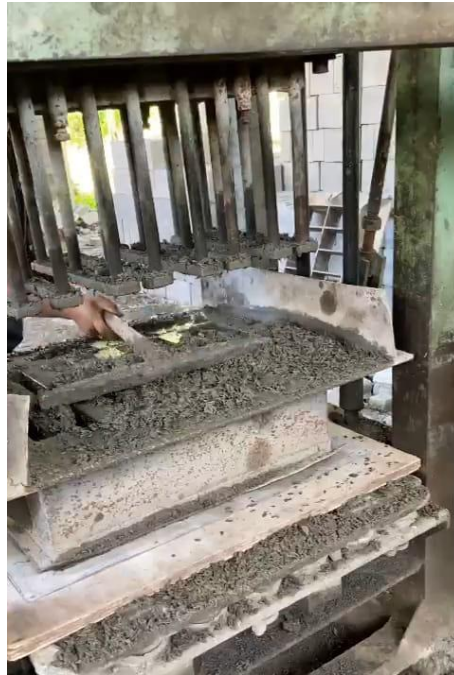
Gambar L-1.3 Proses Pemasukkan dan Perataan Bahan Campuran Batako ke Press Machine
