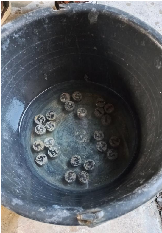
Gambar L-3.3 Proses Perendaman Benda Uji
