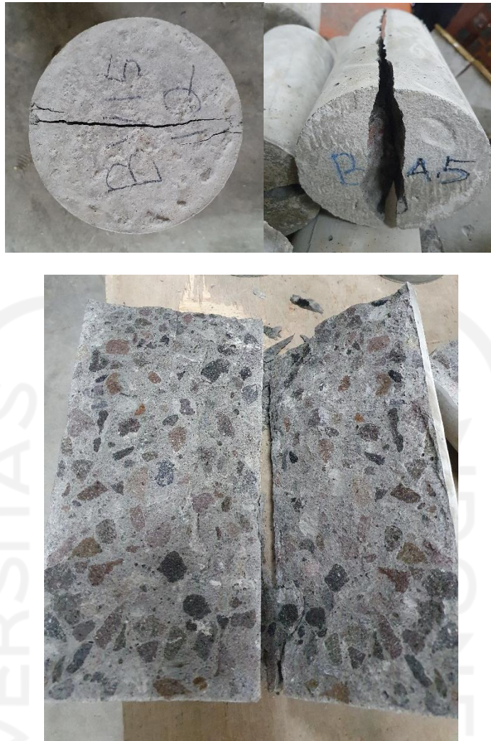
Gambar L-5.4 Hasil Pengujian Kuat Tarik Belah Beton
