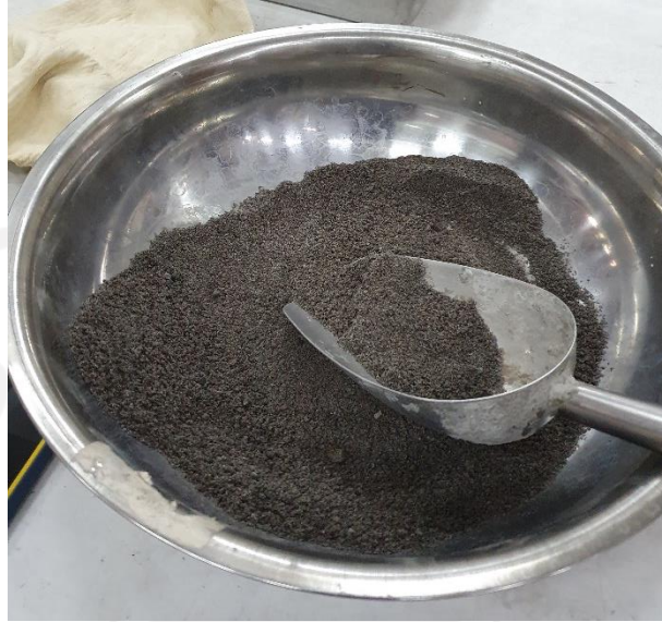
Gambar L-4.1 Agregat Halus dari Gunung Merapi
