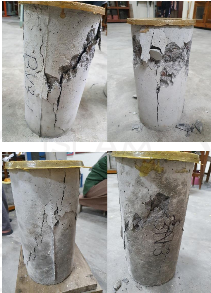
Gambar L-5.3 Hasil Pengujian Kuat Tekan Beton
