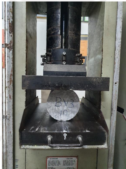
Gambar L-5.2 Proses Pengujian Kuat Tarik Belah Beton
