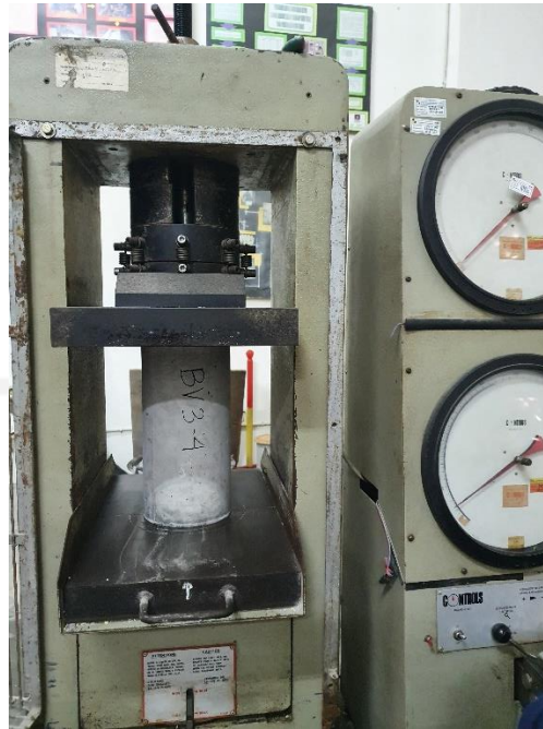
Gambar L-5.1 Proses Pengujian Kuat Tekan Beton
