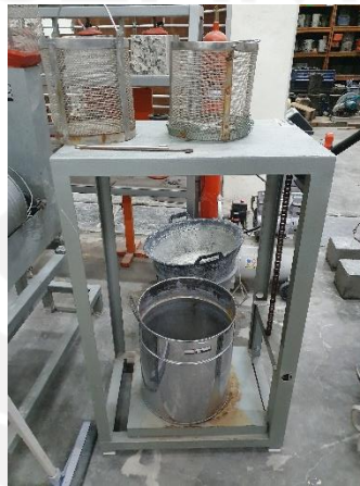
Gambar L-3.2 Pengujian Berat Jenis Agregat Kasar
