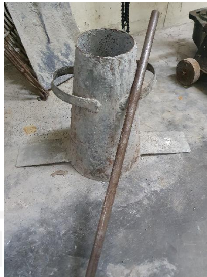
Gambar L-3.10 Kerucut Abrams dan Tongkat Penumbuk
