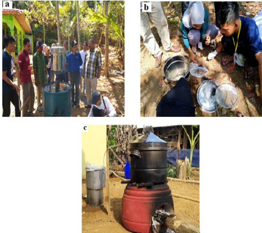
Gambar 4. Proses pirolisis untuk arang dan karbon aktif
