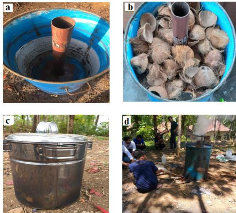
Gambar 3. Proses pengisian dan pirolisis tempurung kelapa kedalam reaktor
