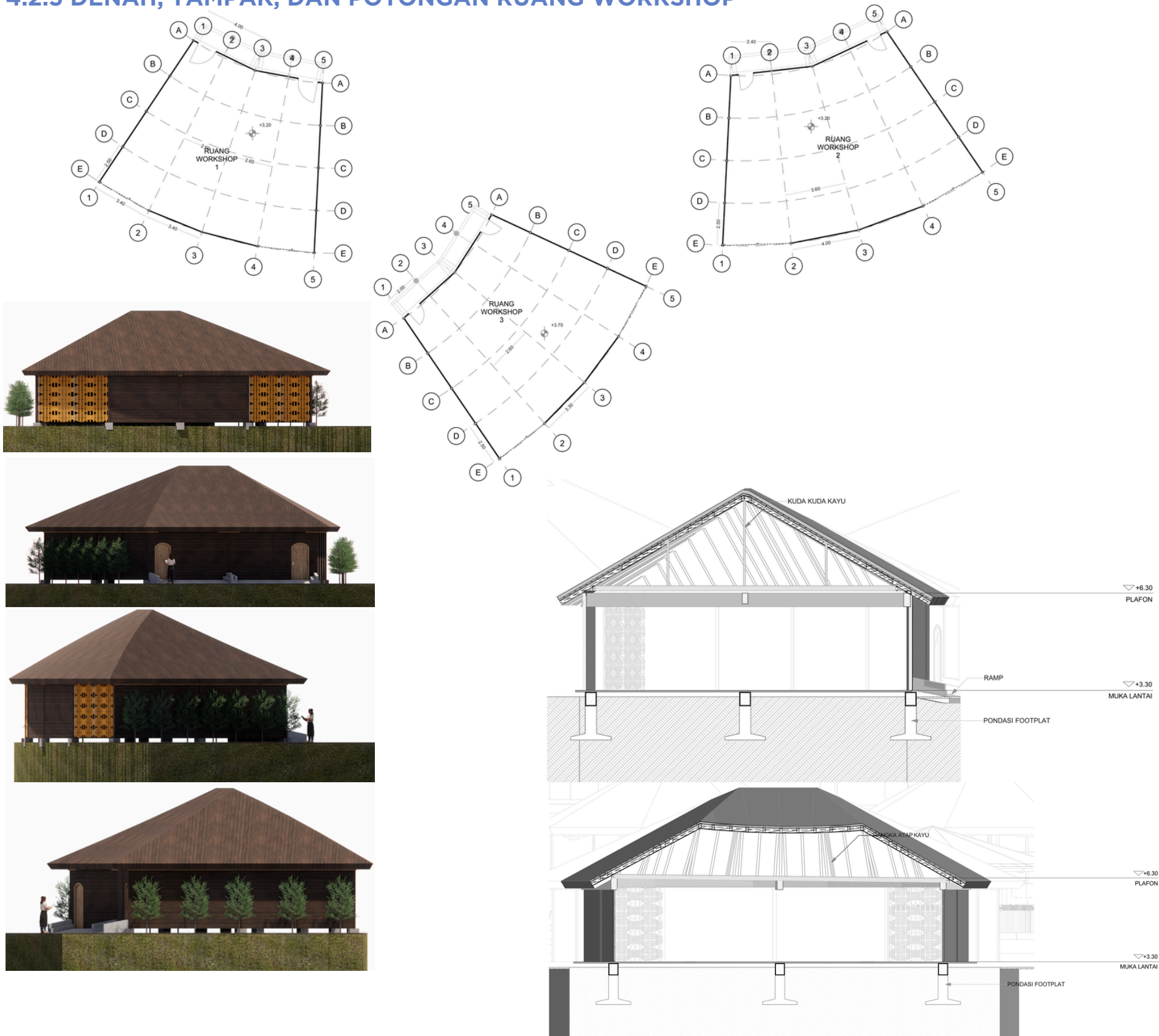
Gambar 4.5 : Denah, tampak, potongan workshop SUMBER : Penulis, 2024
