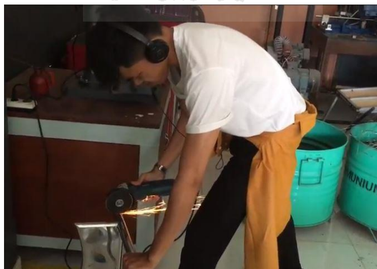
Gambar 4- 11 Proses pemotongan batang stainless
