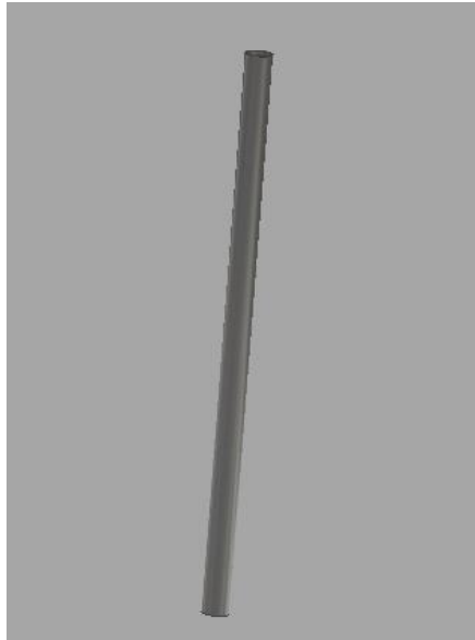
Gambar 4- 4 Poros yang berfungsi sebagai engsel
