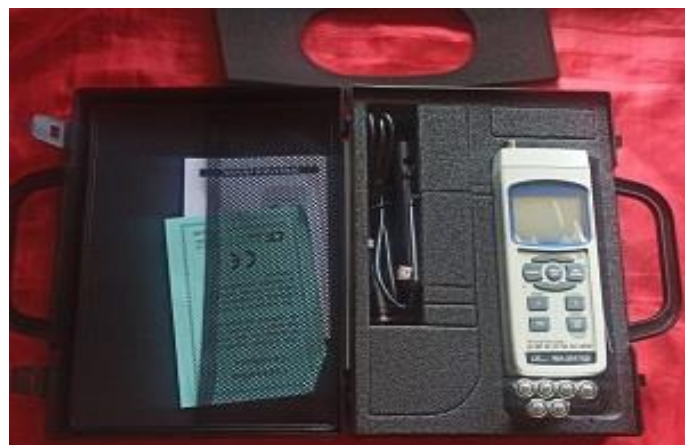
Gambar 3.2 Alat Ukur Kualitas Air Lutron WA-2017SD
