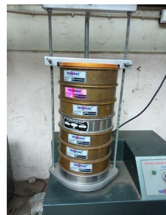
Pengayakan cangkang kerang dengan shieve shaker
