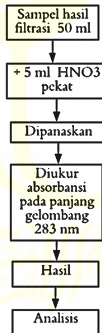
Gambar 3. 10 Cara Kerja Pengukuran Kadar Timbal (Pb) dari sampel
