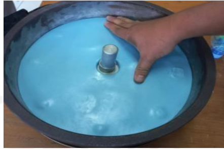
Gambar 3.31 Pemasangan silicone rubber bagian atas
