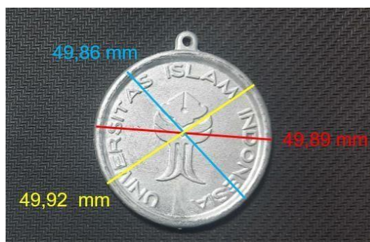
Gambar 4.4 Pengukuran diameter di beberapa titik
