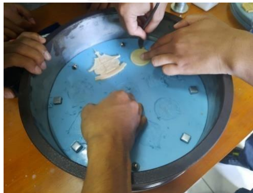
Gambar 3.29 Pembuatan coakan pada silicone rubber
