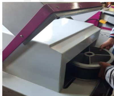
Gambar 3.33 Proses memasukkan cetakan ke mesin vulkanisir
