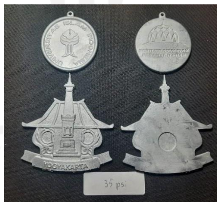
Gambar 4.16 Hasil pengecoran 35 psi
