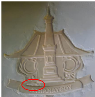
Gambar 4.55 Cetakan silicone rubber rusak
