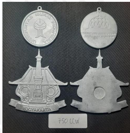
Gambar 4.13 Hasil Pengecoran 750 rpm CCW
