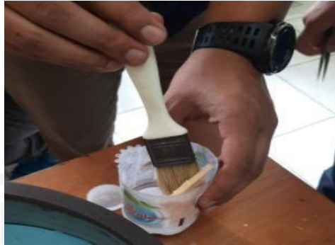
Gambar 3.28 Melapisi lapisan resin pada permukaan master
