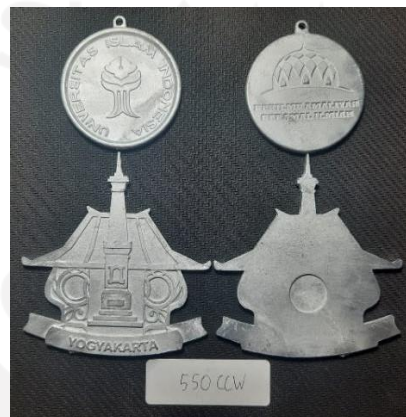
Gambar 4.11 Hasil pengecoran 550 rpm CCW
