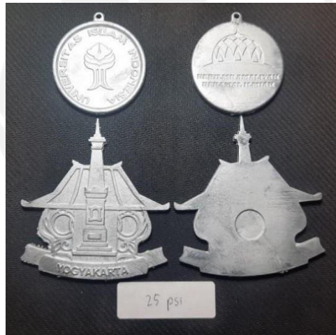
Gambar 4.14 Hasil pengecoran 25 psi
