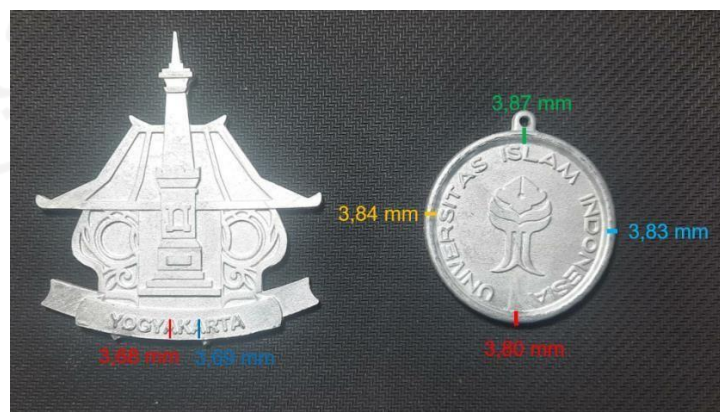
Gambar 4.3 Pengukuran di tebal beberapa titik
