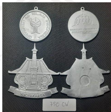
Gambar 4.9 Hasil pengecoran 750 rpm CW
