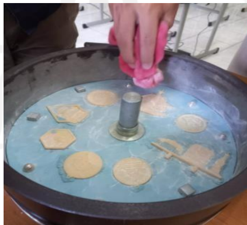
Gambar 3.30 Peletakan master dan pemberian bedak pada silicone rubber
