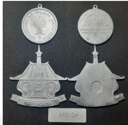
Gambar 4.8 Hasil pengecoran 650 rpm CW
