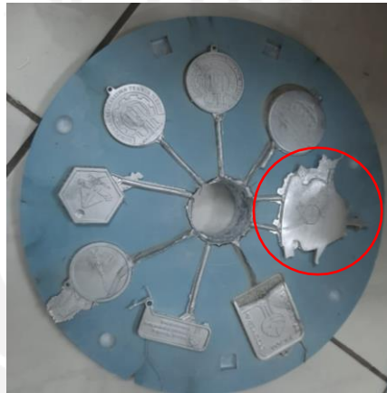
Gambar 4.54 Muncul sirip atau flash pada hasil pengecoran
