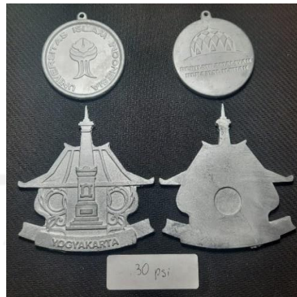
Gambar 4.15 Hasil pengecoran 30 psi
