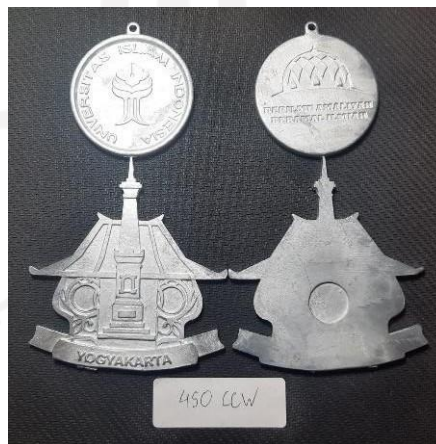
Gambar 4.10 Hasil pengecoran 450 rpm CCW
