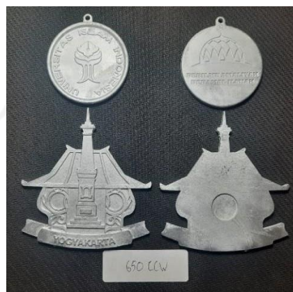
Gambar 4.12 Hasil pengecoran 650 rpm CCW
