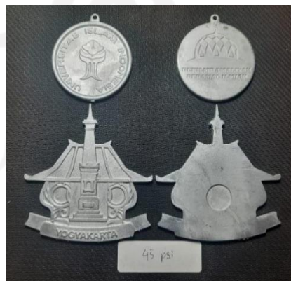
Gambar 4.18 Hasil pengecoran 45 psi
