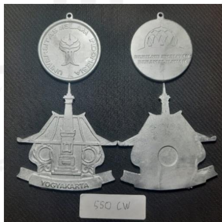
Gambar 4.7 Hasil pengecoran 550 rpm CW
