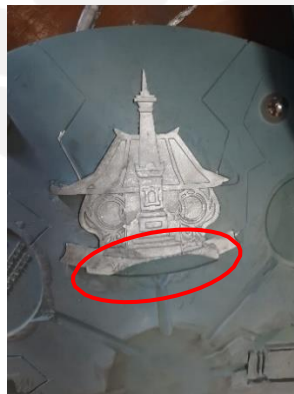
Gambar 4.53 Cetakan tidak terisi sempurna
