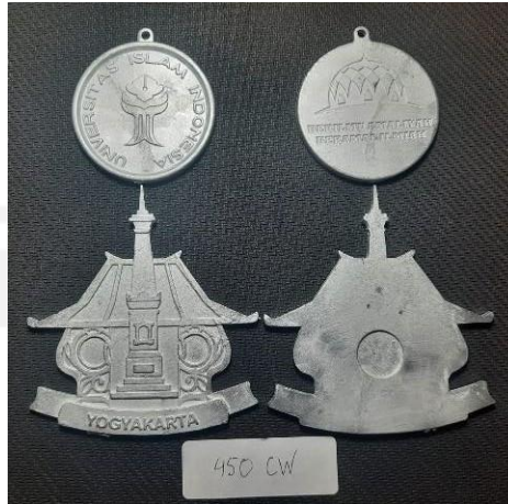
Gambar 4.6 Hasil pengecoran 450 rpm CW
