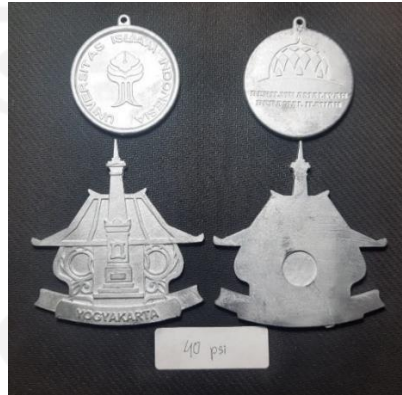
Gambar 4.17 Hasil pengecoran 40 psi
