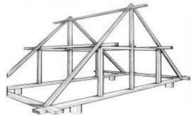
Gambar 2.31 Konstruksi rangka atap (bubungan) yang disebut sangga ribut Sumber: Mentayani (2008)
