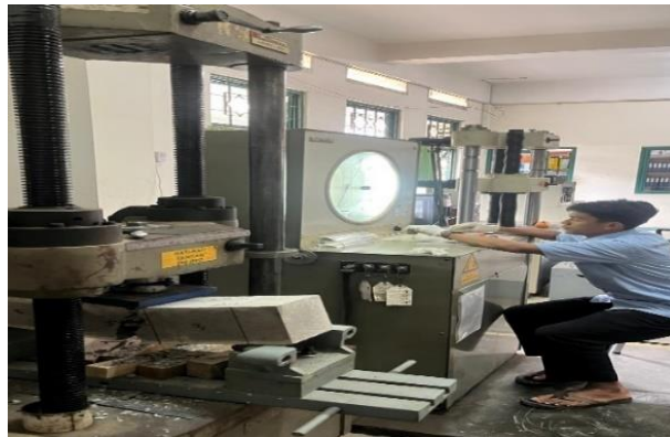
Gambar 5.24 Pengujian Kuat Lentur Pada Beton
