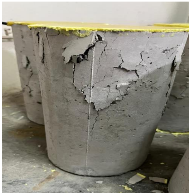
Gambar 5.15 Kondisi Benda Uji Setelah Pengujian Kuat Tekan Beton
