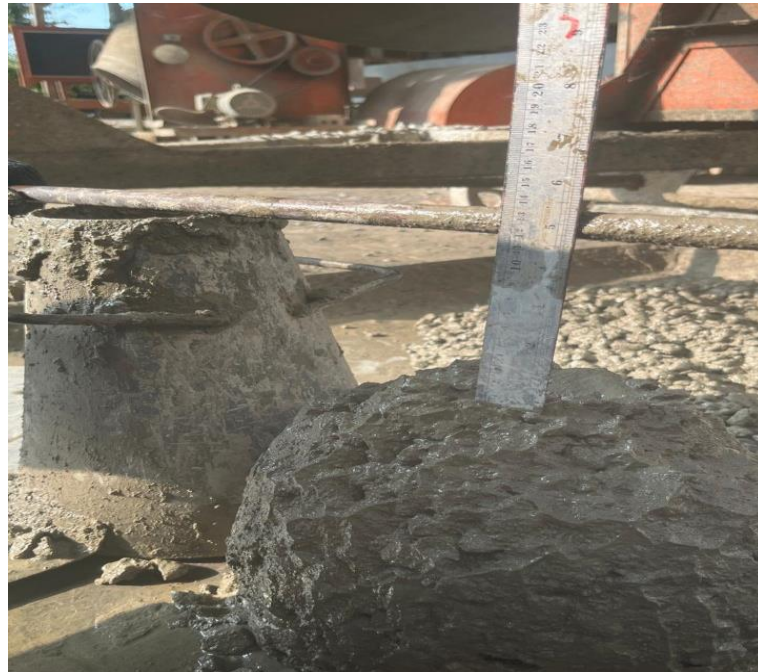
Gambar L-8.1 Hasil Pengujian Slump Test
