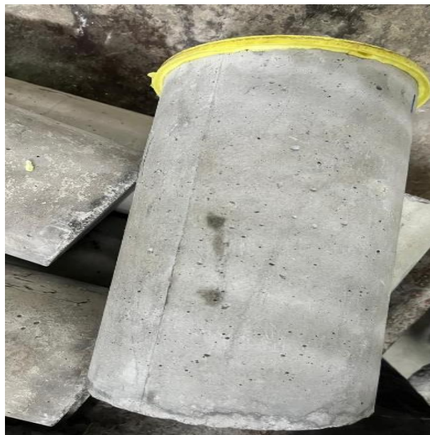
Gambar 5. 14 Kondisi Benda Uji Sebelum Pengujian Kuat Tekan Beton
