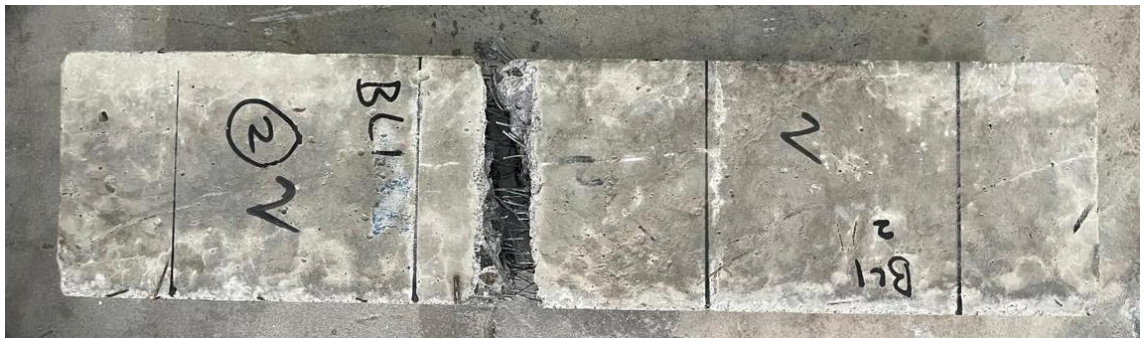
Gambar L-11.2 Hasil Pengujian Kuat Lentur
