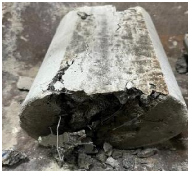
Gambar 5.18 Kondisi Benda Uji Setelah Pengujian Kuat Tarik Belah Beton
