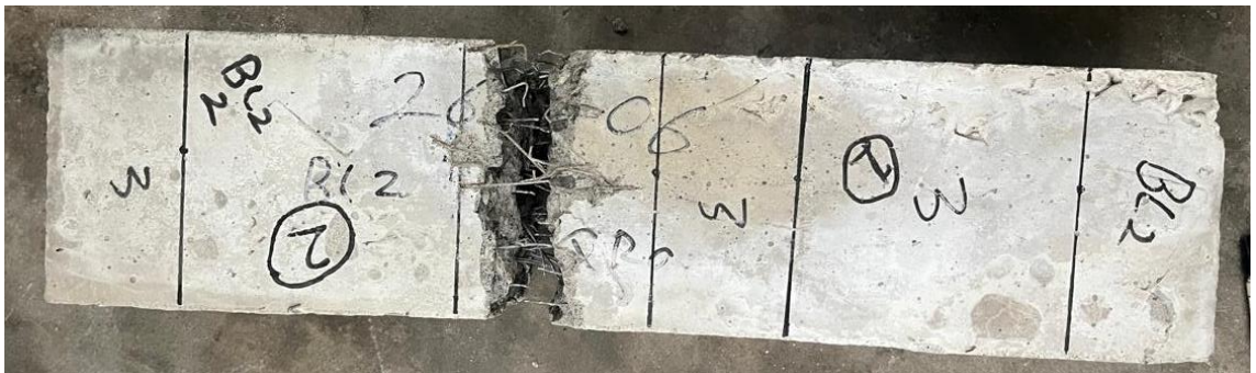
Gambar L-11.3 Hasil Pengujian Kuat Lentur
