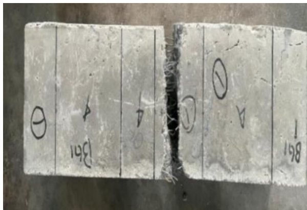
Gambar 5.26 Kondisi Benda Uji Setelah Pengujian Kuat Lentur
