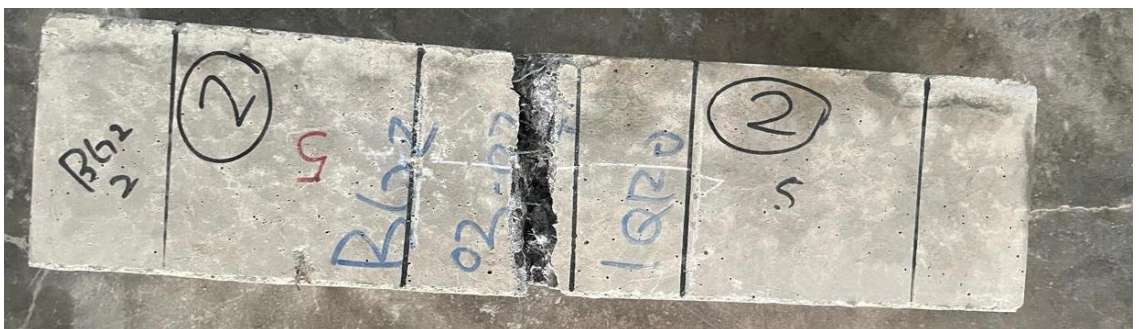
Gambar L-11.4 Hasil Pengujian Kuat Lentur
