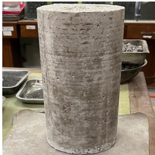
Gambar 5. 17 Kondisi Benda Uji Sebelum Pengujian Kuat Tarik Belah Beton
