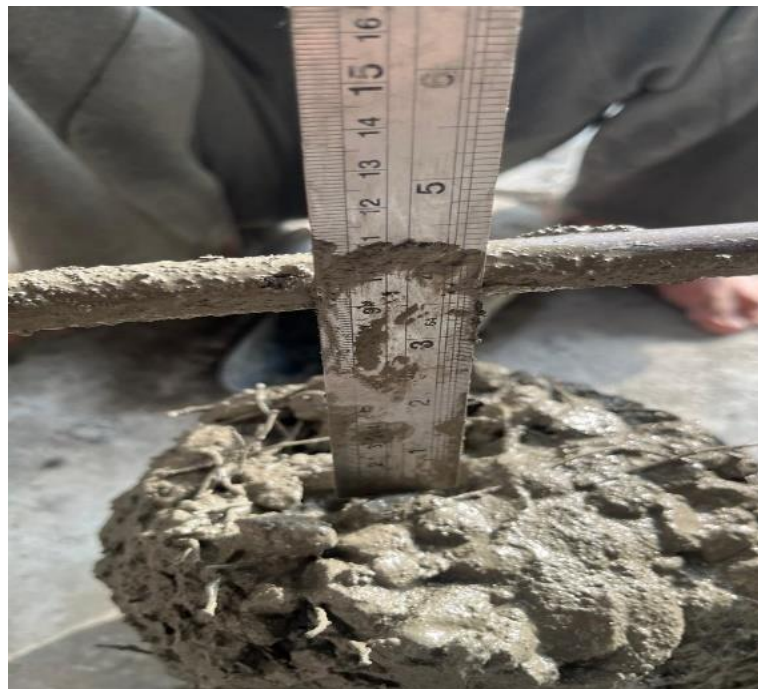
Gambar L-8.2 Hasil Pengujian Slump Test
