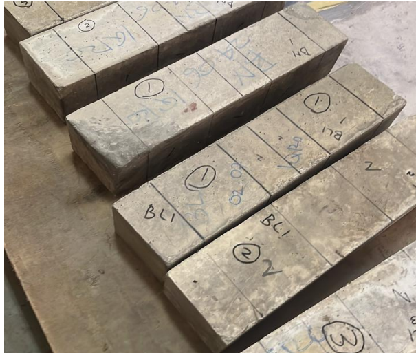
Gambar 5. 25 Kondisi Benda Uji Sebelum Pengujian Kuat Lentur
