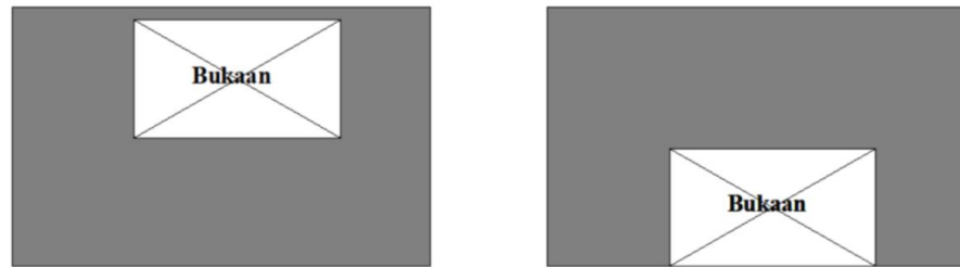
Gambar 3. 9 Ketidakberaturan Diskontinuitas Diafragma
