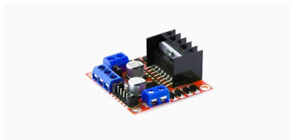
Gambar 2.9 L298N Mengatur Kecepatan PWM Fan Mini.
