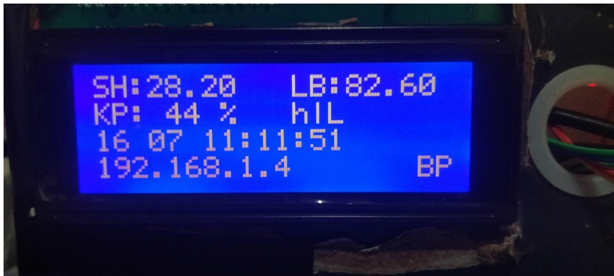
Gambar 3.14 Informasi pada LCD 20x4 Mengenai Kondisi Kumbung.
