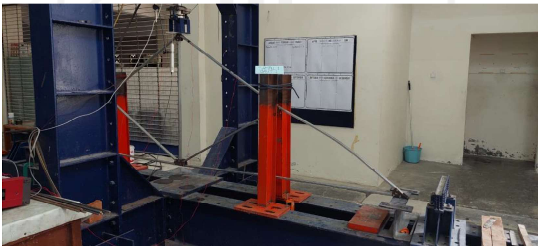
Gambar 5.15 Kondisi Benda Uji Rangka Atap Variasi Jumlah Sambungan 1 Baut Sampel 1
