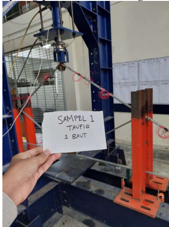
Lampiran A.7 Set up Pengujian Tekan Pada Batang Tekan Variasi 3 Baut
