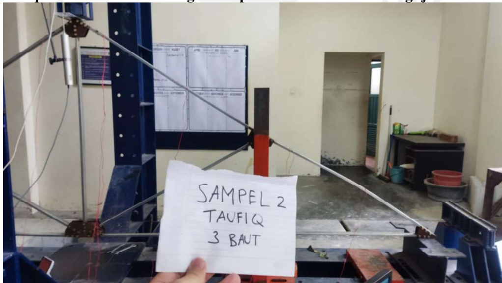
Lampiran A.8 Kondisi Rangka Atap Setelah Dilakukan Pengujian Tekan
