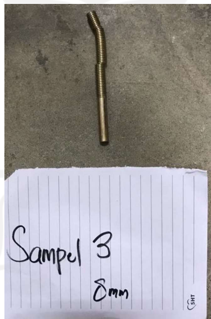
Gambar 5.8 Kondisi Baut Sampel 3 Setelah Pengujian
