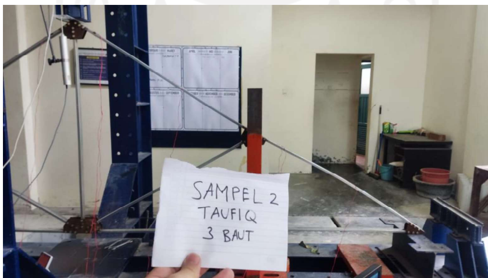
Gambar 5.24 Kondisi Benda Uji Rangka Atap Variasi Jumlah Sambungan 3 Baut Sampel 2
