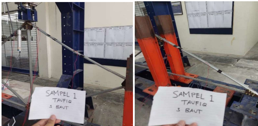
Gambar 5.23 Kondisi Benda Uji Rangka Atap Variasi Jumlah Sambungan 3 Baut Sampel 1
