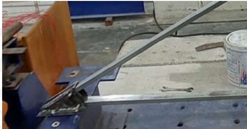
Gambar 5.39 Cover Sepatu Pada Pengujian Kuat Tekan Rangka Atap
