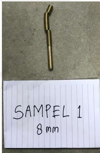
Gambar 5.6 Kondisi Baut Sampel 1 Setelah Pengujian
