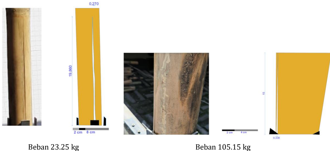
Gambar 18 dan 19. kerusakan pada bambu Sumber: Dokumentasi Penulis
