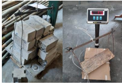
Gambar 7 dan 8. Beban Maksimum 122.5 kg dan Berat Penampang 2.72 kg Sumber: Dokumentasi Penulis
