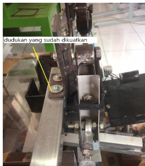
Gambar 4.15 Dudukan Stapler yang dikuatkan
