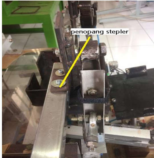
Gambar 4.4 Mengganti Penopang Stapler
