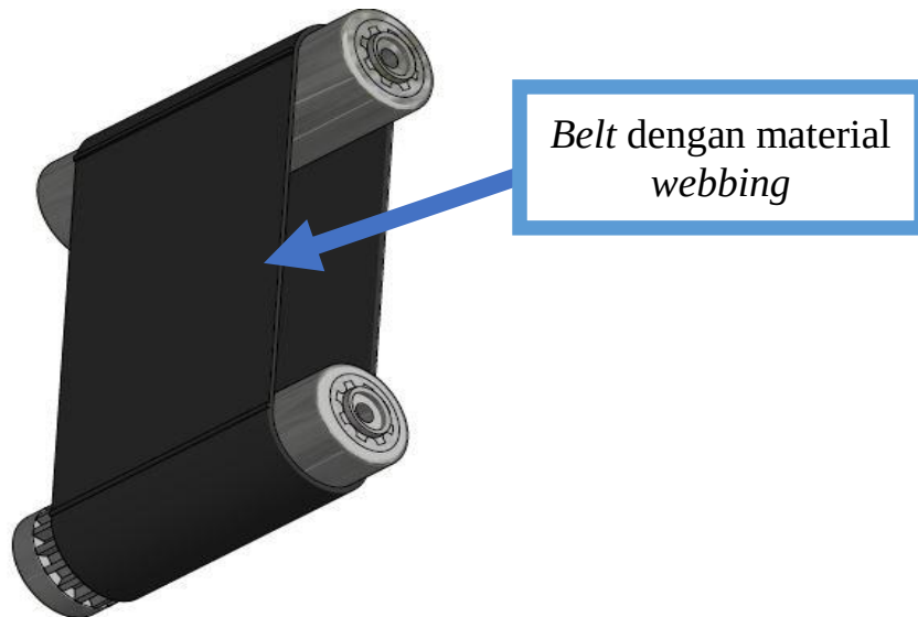
Gambar 3. 16 Material belt yang diganti
