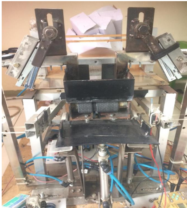
Gambar 4.1 Hasil Perancangan Alat Penekuk Karton lunch box
