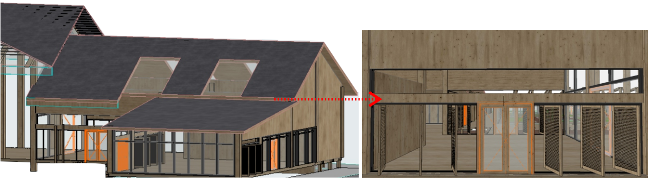
Gambar 3.45. Penerapan Alat Bayang pasif berupa louvre pada area komersil Sumber: Analisis Penulis, 2025
