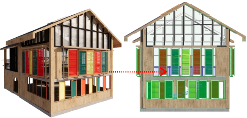
Gambar 3.46. Penerapan Alat Bayang pasif berupa louvre pada area edukasi Sumber: Dokumen Penulis, 2025
