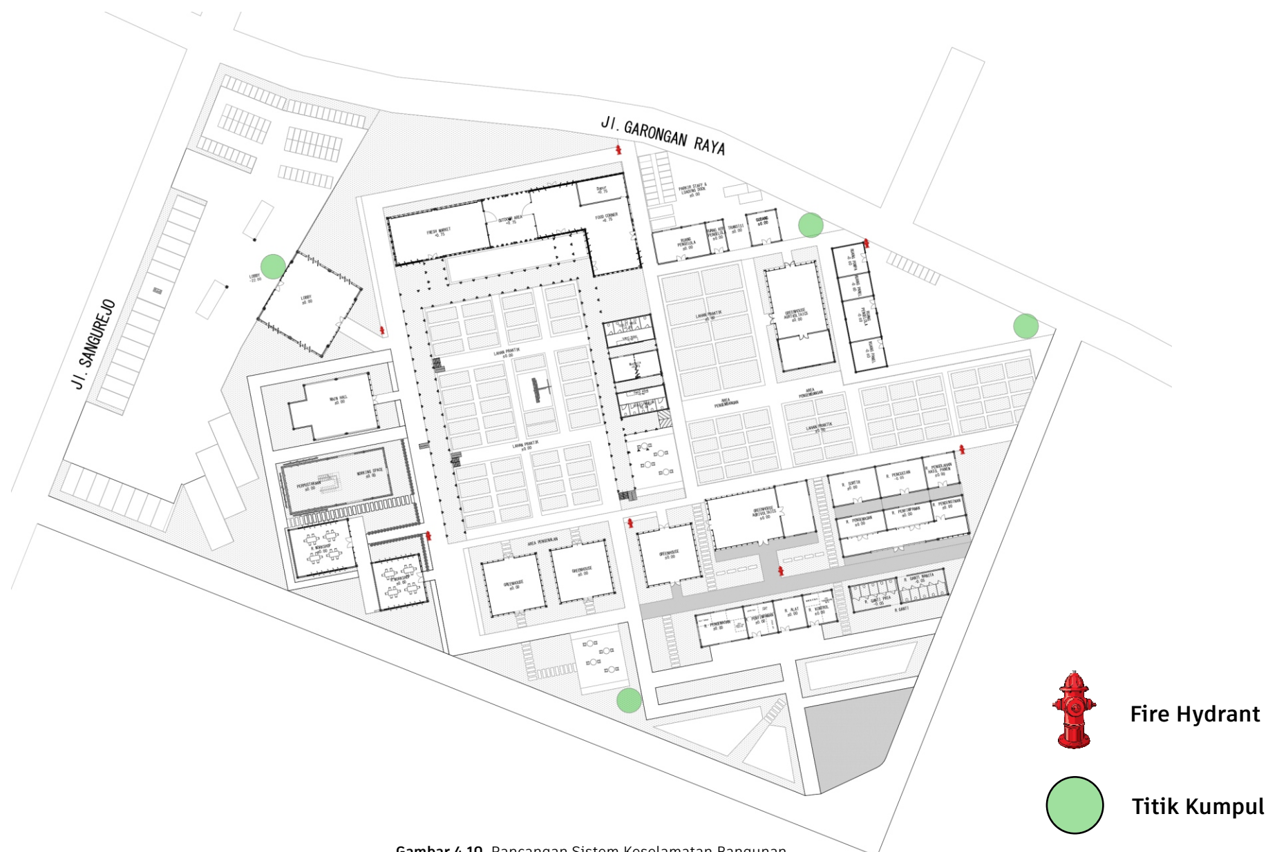
Gambar 4.10. Rancangan Sistem Keselamatan Bangunan Sumber: Data Penulis, 2025
