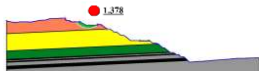
Gambar 8. SF pada Inter-Ramp 1 Slope/W
