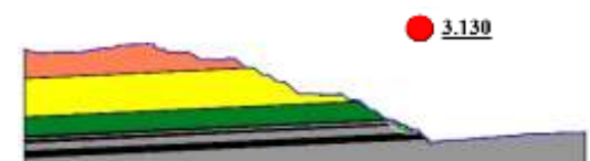
Gambar 10. SF pada Inter-Ramp 3 Slope/W
