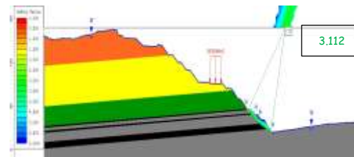
Gambar 14. SF pada Inter-Ramp 3 SLIDE
