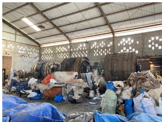
Gambar 4. 3 Tannery Drum (Sumber Gambar: Dokumentasi Pribadi, 2025)
