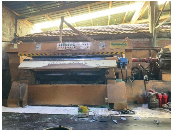
Gambar 4. 2 Italian Shaving Machine (Sumber Gambar: Dokumentasi Pribadi, 2025)
