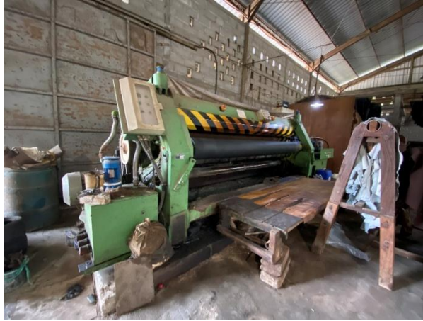
Gambar 4. 4 France Setting Out Machine (Sumber Gambar: Dokumentasi Pribadi, 2025)
