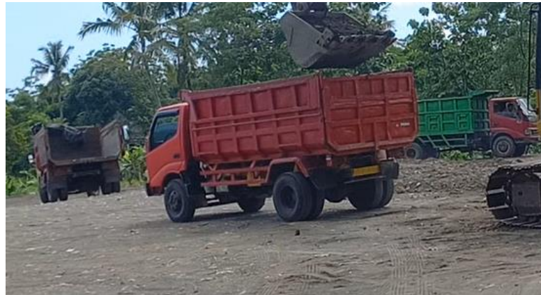
Gambar 5.17 Dump Truck Berhenti Karena Menunggu Antrean Excavator
