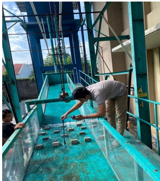
Gambar 5. 3 Pengukuran Kecepatan Aliran dengan Current Meter
