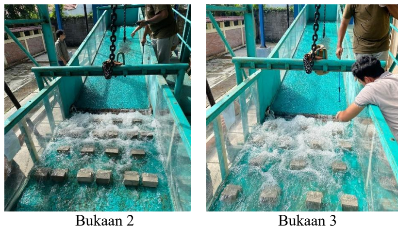
Gambar 5. 2 Aliran Dengan Baffle Blocks pada Bukaan 2 dan 3
