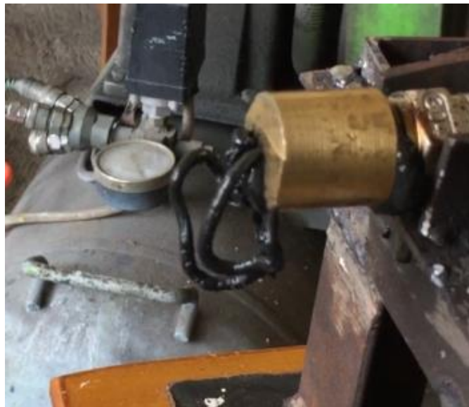
Gambar 4-20 Bentuk filamen pada suhu dibawah 160°C.
