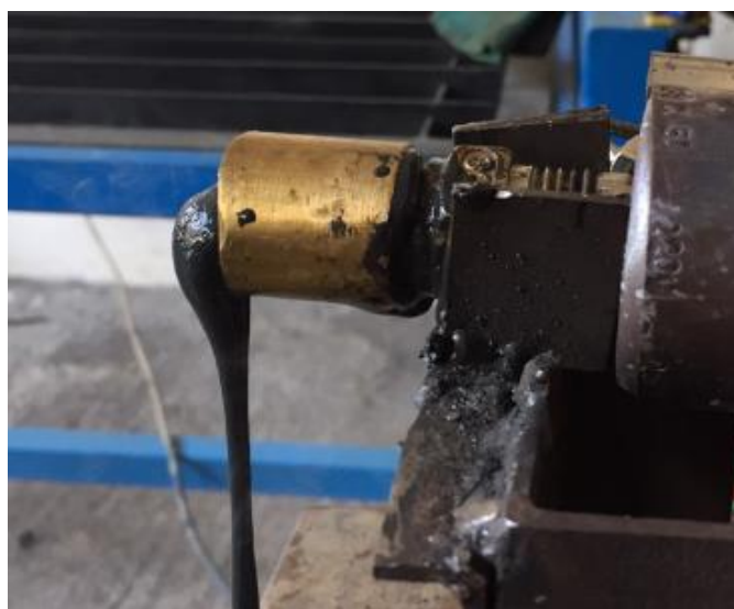
Gambar 4-19 Penggumpalan filamen pada suhu lebih dari 165°C
