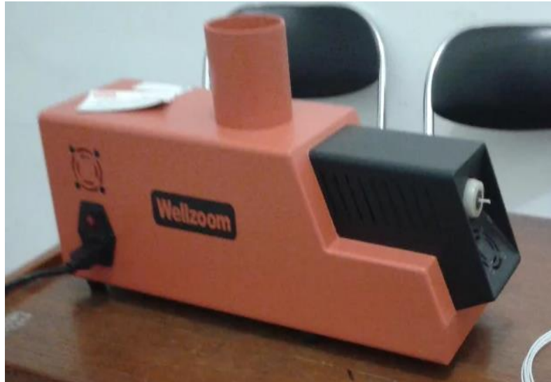
Gambar 2-1 Mesin ekstruder filamen 3D printer di pasaran. (Bukalapak, 2015)
