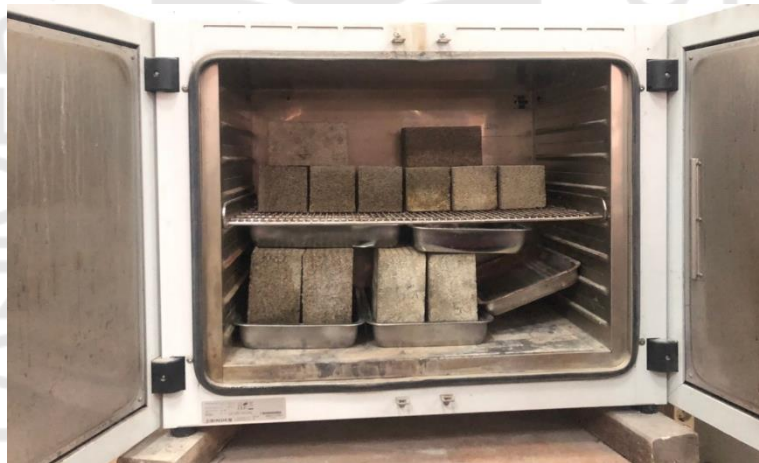
Gambar 4.12 Proses Pengeringan Batako Setelah Direndam
