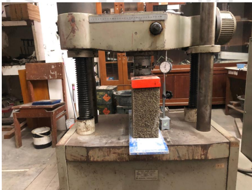
Gambar L-2.2 Pengujian Kuat Tekan
