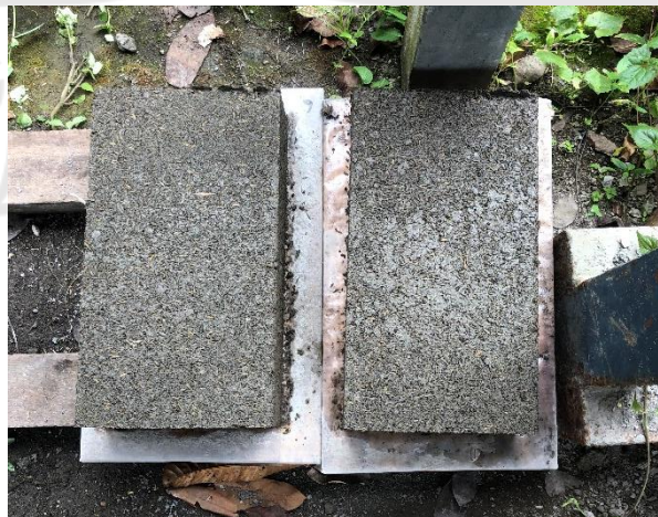
Gambar 4.6 Hasil Batako Yang Telah Dipress
