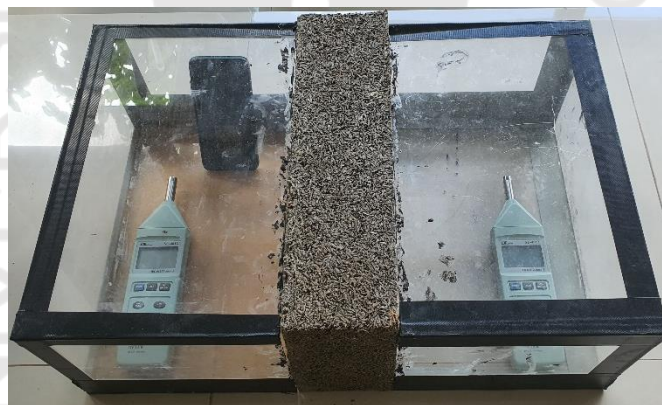
Gambar 4.14 Pengujian Daya Redam Suara
