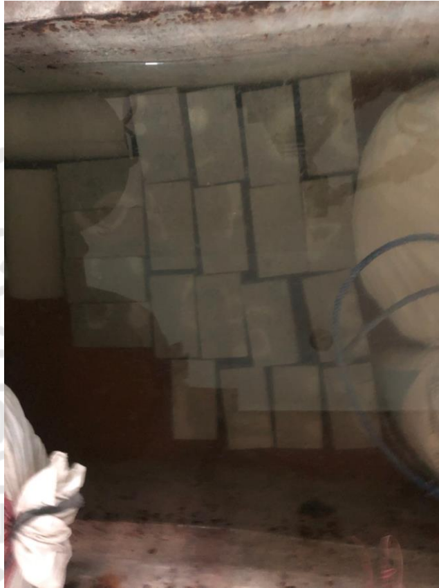
Gambar L-3.1 Perendaman Benda Uji
