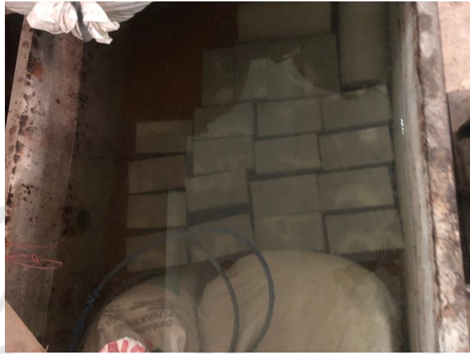
Gambar 4.11 Proses Perendaman Batako Selama 24 Jam
