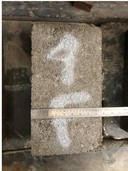
Gambar 4.11 Pengukuran Dimensi Batako
