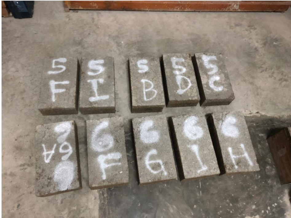
Gambar L-2.1 Benda Uji Sebelum Diuji Kuat Tekan
