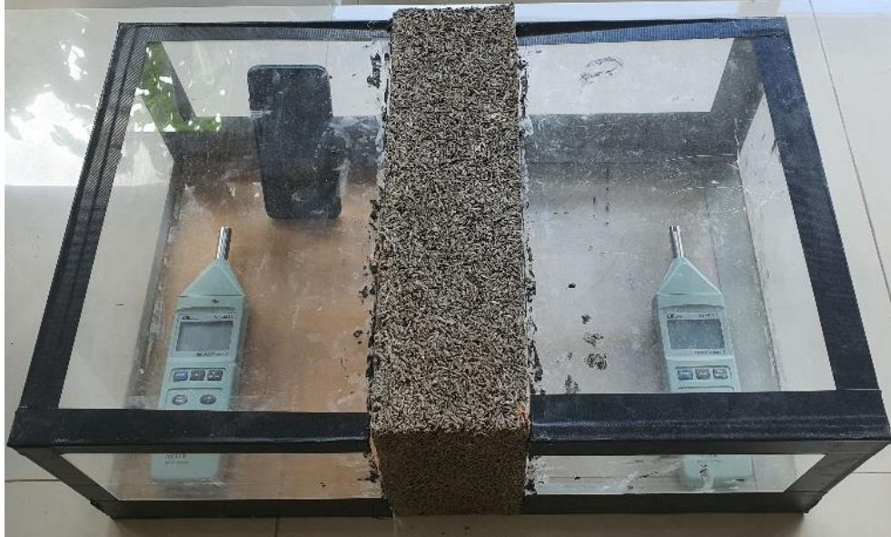
Gambar L-4.1 Pengujian Redaman Suara Pada Benda Uji
