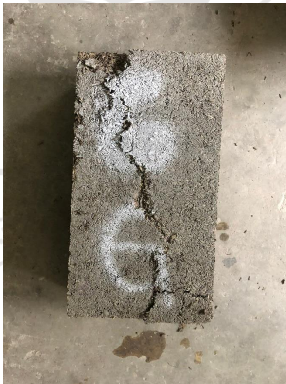
Gambar 4.9 Batako Setelah Diuji Tekan
