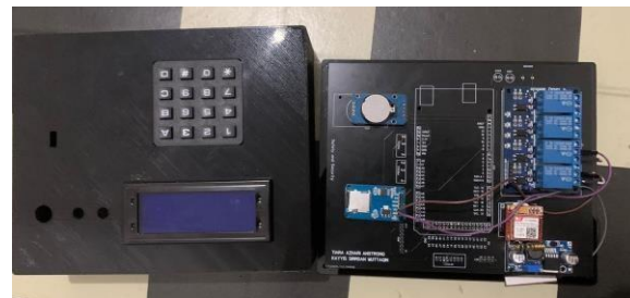
Gambar 12. Komponen yang sudah terpasang di PCB
