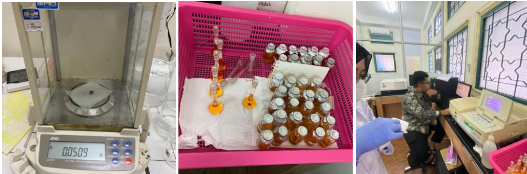
Gambar 3. 7 Prose pengujian TOC dengan Spektrofotometri
