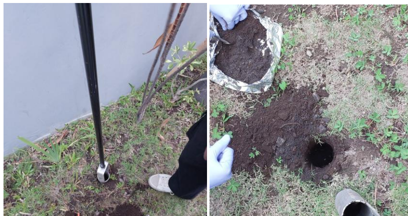
Gambar 3. 3 Proses Pengambilan Sampel Menggunakan Bor Tangan
