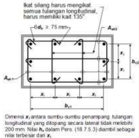
Gambar 3.13 Contoh penulangan transversal pada kolom
