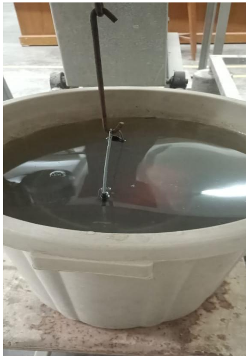
Gambar 4.4 Proses penentuan berat dalam air
