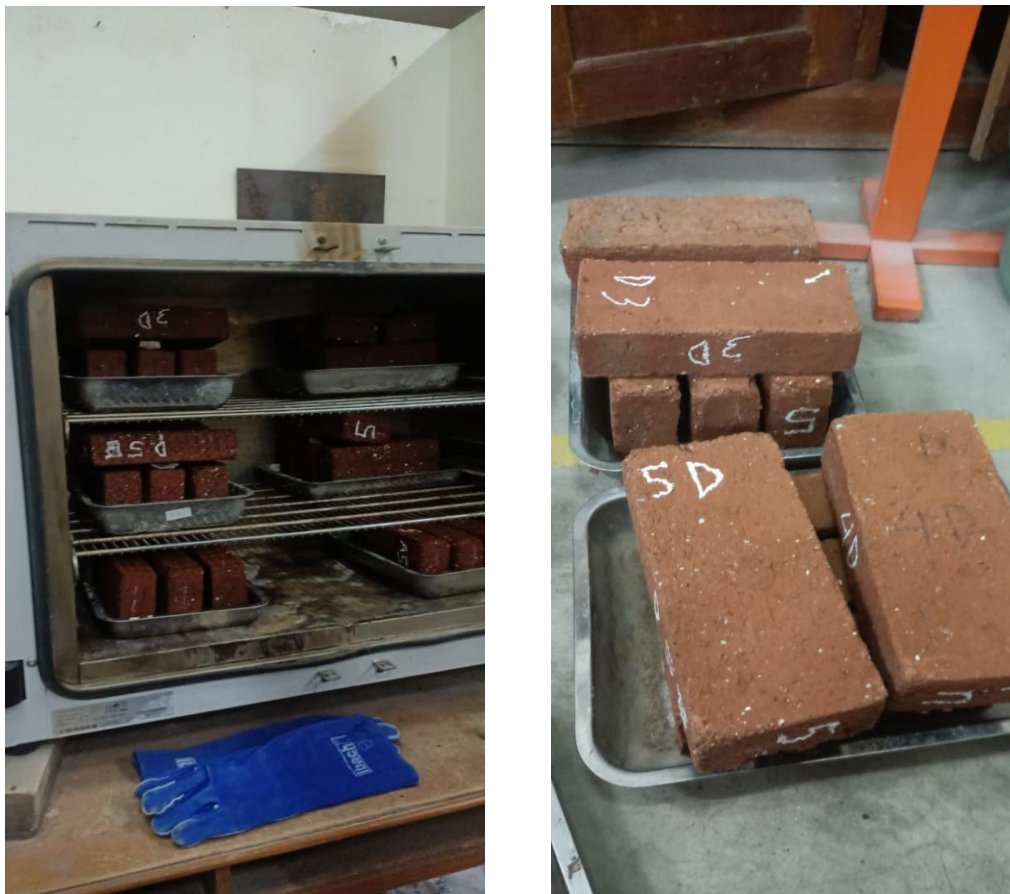
Gambar 4.6 Proses pengeringan dalam oven dan pendinginan
