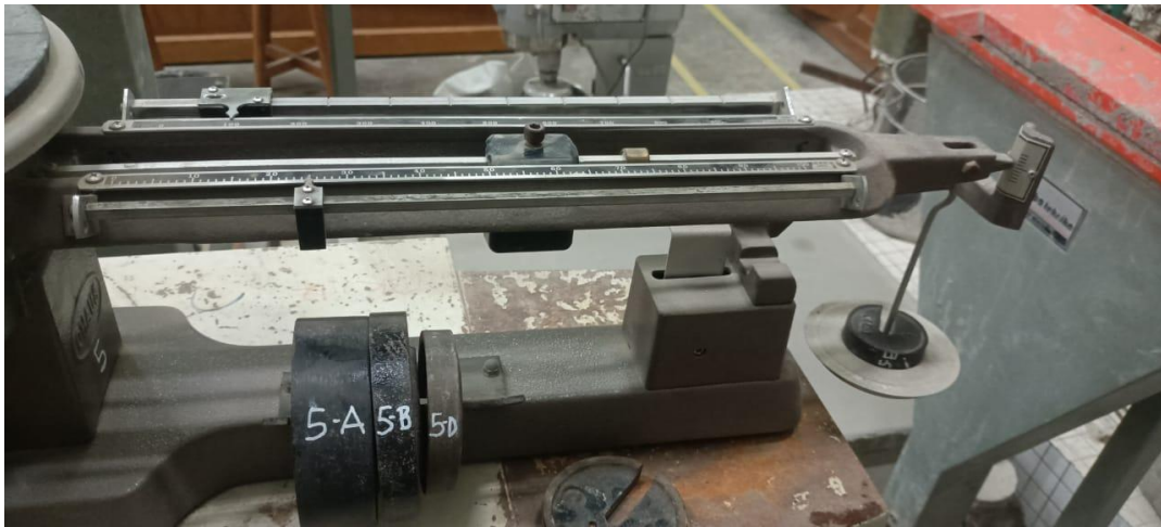
Gambar 4.5 Penggunaan neraca 3 lengan sebagai alat ukur
