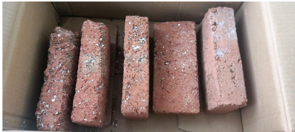
Gambar 4.2 Batu bata setelah dibakar
