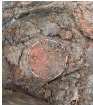
Gambar 3. 7 Pengambilan Sampel Tanah menggunakan ring sample pada Mangrove Baros
