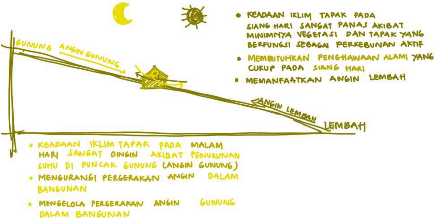
Gambar 3.1.7 Ilustrasi Cara Kerja Angin Lembah dan Angin Gunung dalam Bentuk Potongan Kontur Sumber : Penulis, 2024
