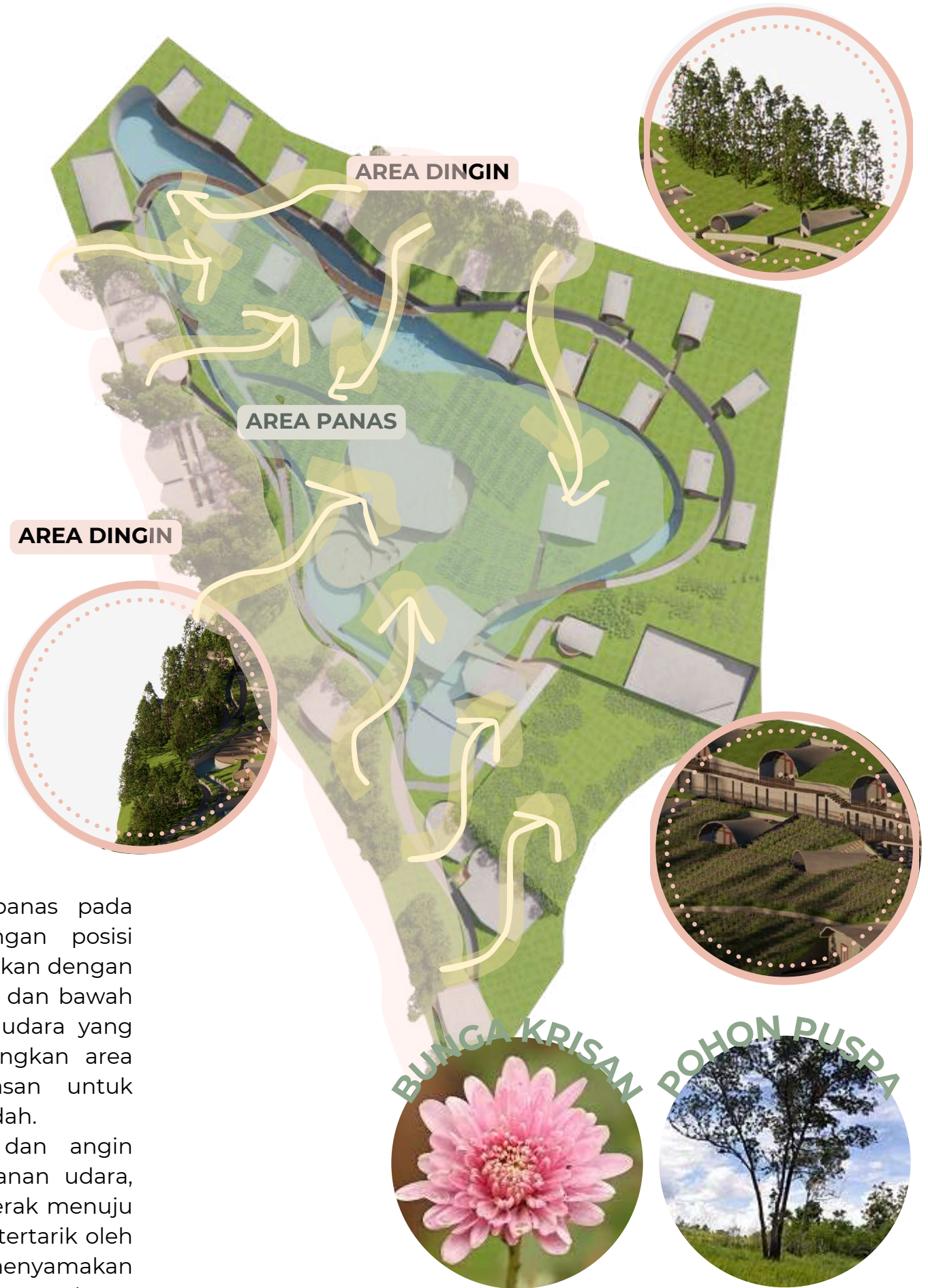
Gambar 4.1.2 Rancangan Lanskap dan Skema Sirkulasi Udara Tapak Sumber: Penulis, 2024
