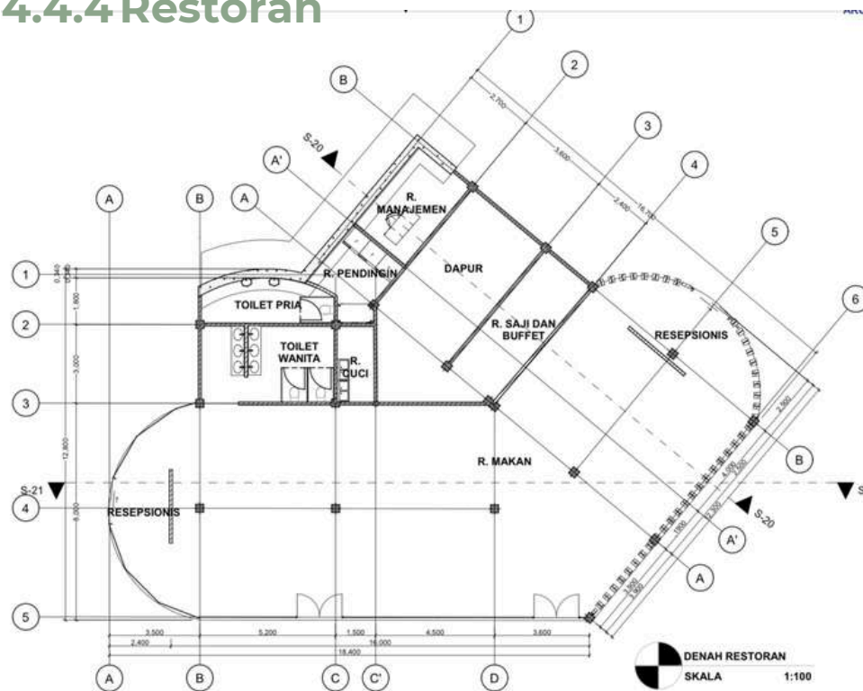
Gambar 4.4.13 Denah Restoran Sumber: Penulis, 2024
