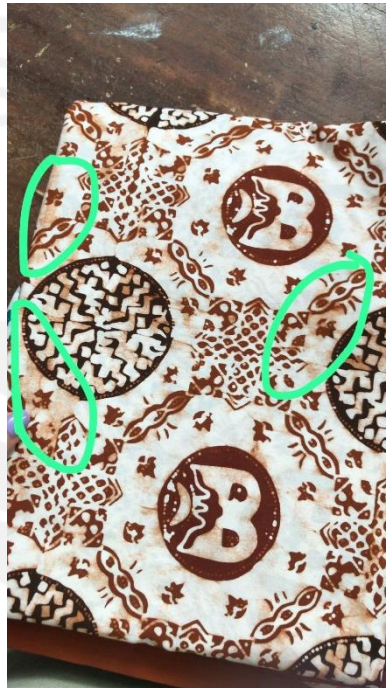
Gambar 4. 15 Jenis Cacat Warna Tidak Merata
