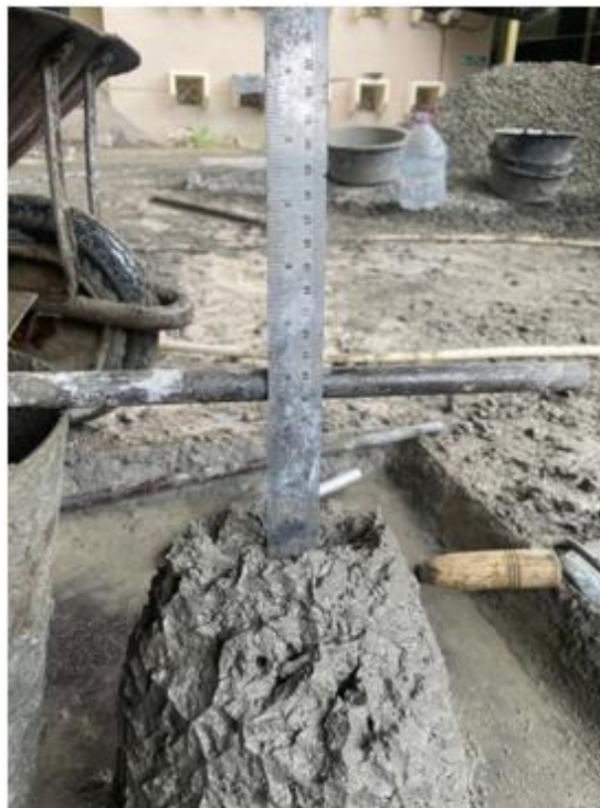
Gambar L-8.2 Pengujian Slump Beton
