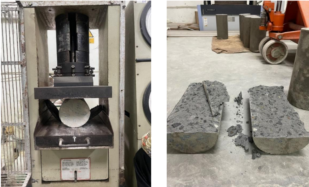
Gambar 5.14 Pengujian Kuat Tarik Belah dan Sampel Benda Uji Setelah Pengujian
