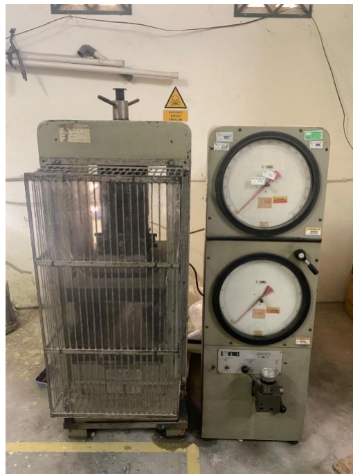
Gambar 4.22 Mesin Uji Kuat Tarik Belah Beton
