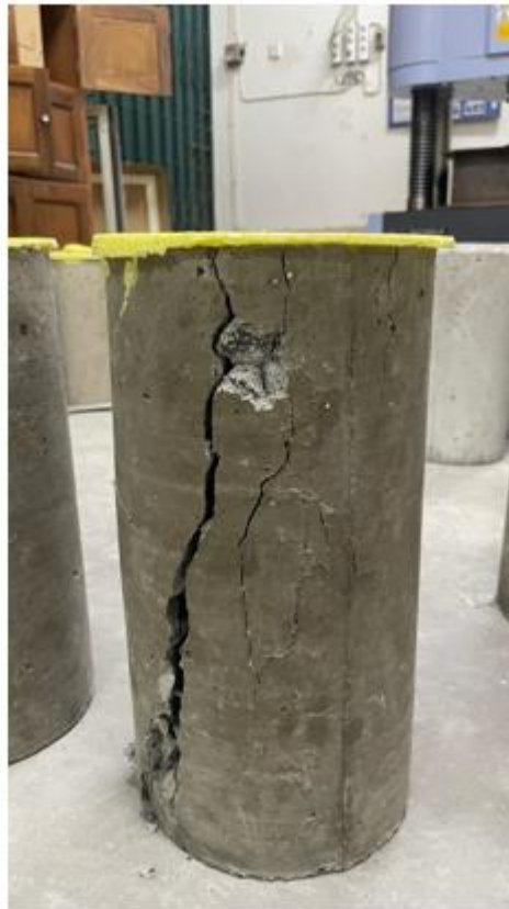
Gambar L-8.7 Pola Keretakan Pengujian Kuat Tekan Beton
