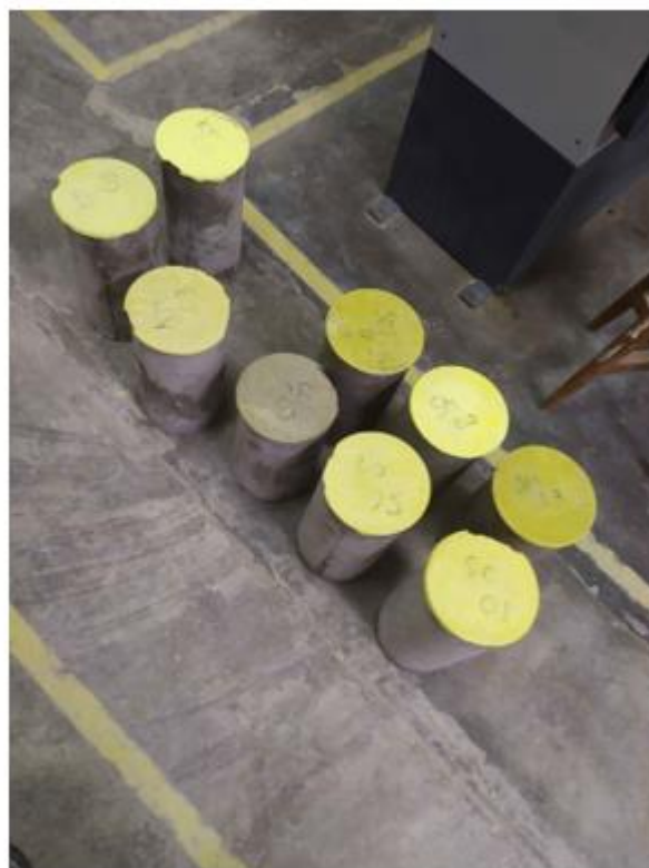
Gambar L-8.4 Sampel Silinder Setelah di Capping
