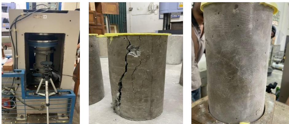
Gambar 5.11 Pengujian Kuat Tekan dan Sampel Benda Uji Setelah Pengujian
