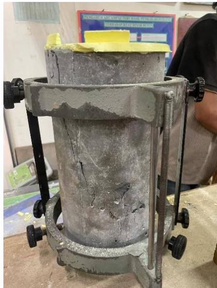
Gambar 5.17 Benda Uji Dipasang Alat Ekstensometer
