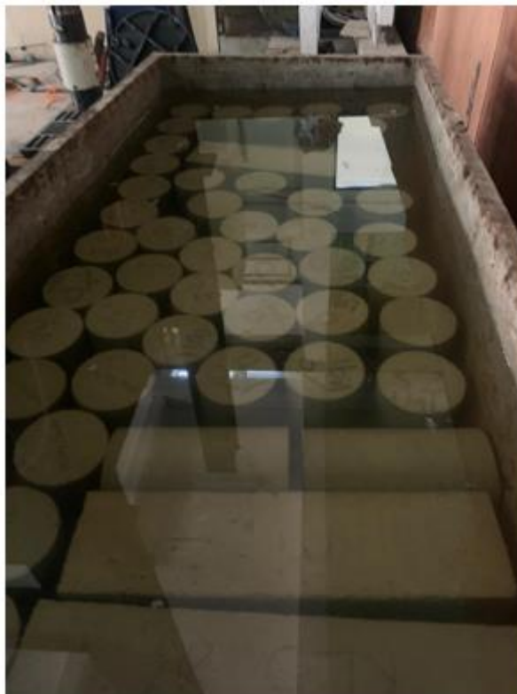
Gambar L-8.3 Perendaman Sampel Beton
