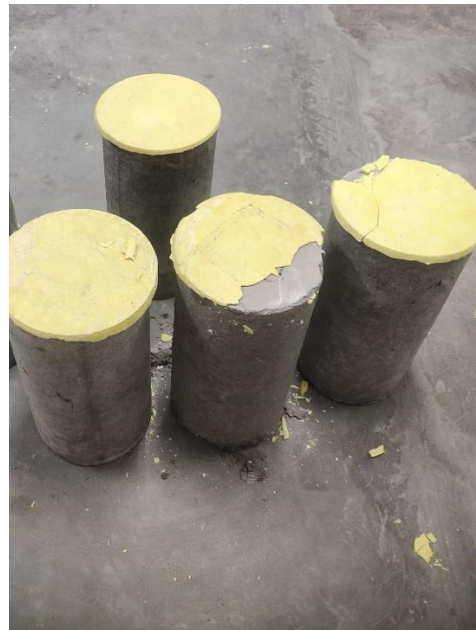
Gambar L-5.4 Benda Uji Setelah Pengujian Kuat Tekan Beton
