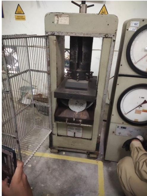
Gambar L-5.3 Pengujian Kuat Tarik Beton
