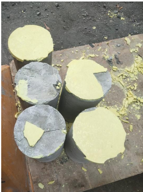
Gambar L-5.4 Benda Uji Setelah Pengujian Kuat Tekan Beton
