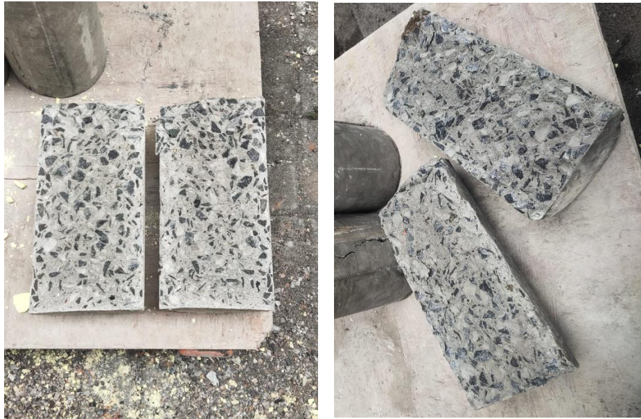
Gambar L-5.5 Benda Uji Setelah Pengujian Kuat Tarik Beton
