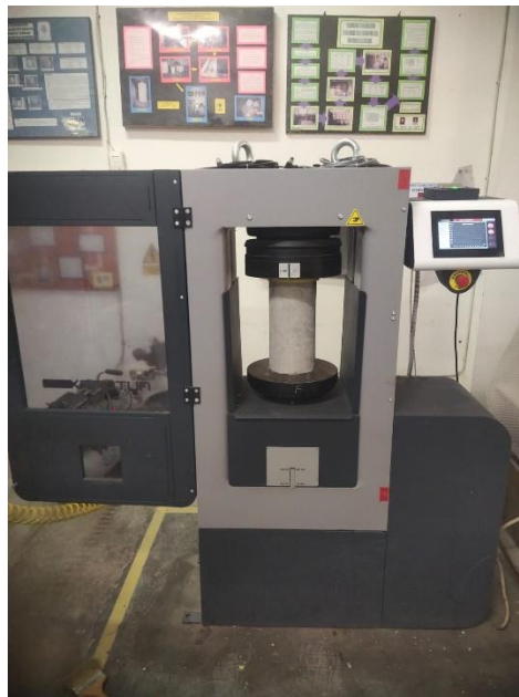
Gambar L-5.2 Pengujian Kuat Tekan Beton
