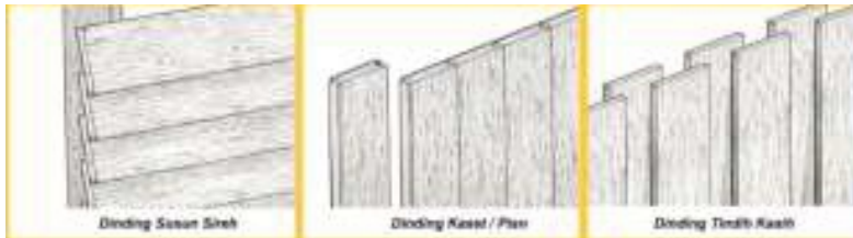
Gambar Ragam Desain Penyusunan Dinding Kayu
