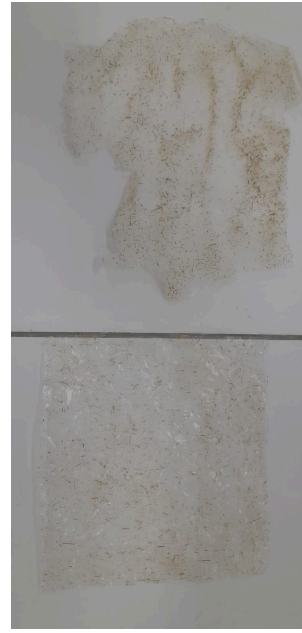
Gambar 15. Bioplastik Metode Biologi (a). Bioplastik Metode Kimia (b).
