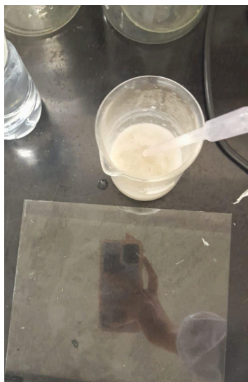
Gambar 10. Pra-cetak Film Bioplastik
