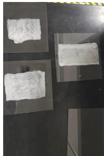
Gambar 12. Pencetakan Bioplastik Metode Kimia
