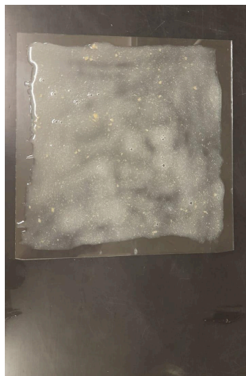
Gambar 11. Pencetakan Bioplastik Metode Biologi
