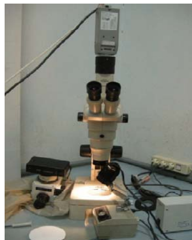
Gambar 3-6 Alat Uji Foto Makro
