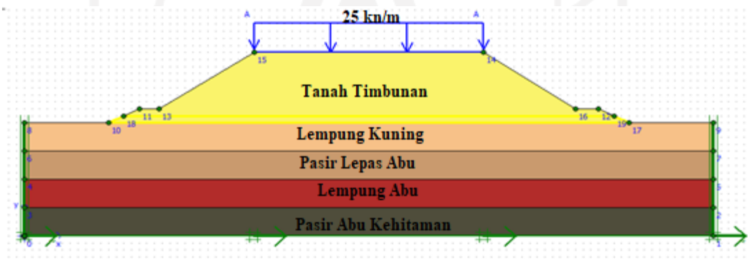
Gambar 5.44 Permodelan Timbunan 10 m yang Diperkuat Dengan Geotekstil Menggunakan Plaxis 8.2
