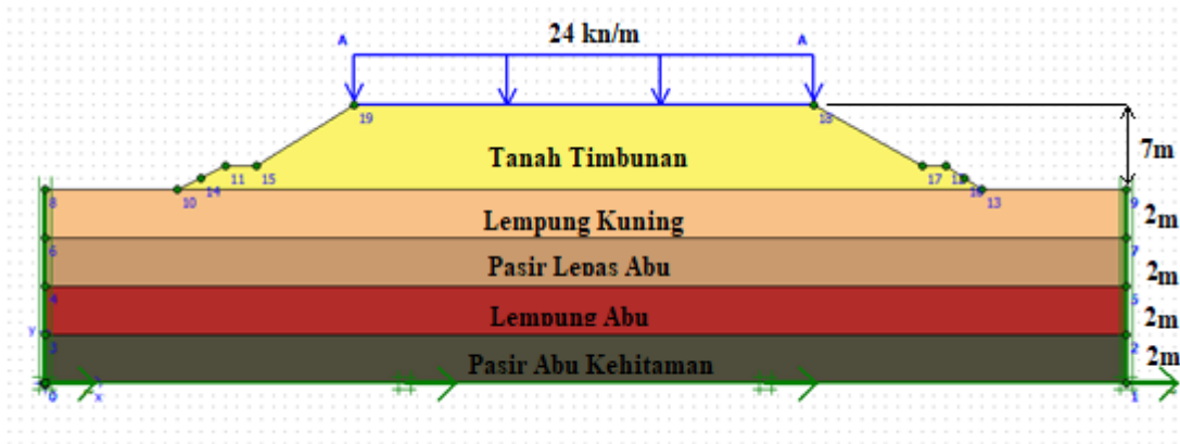
Gambar 5.21 Permodelan Timbunan 7 m Tanpa perkuatan Dengan Menggunakan Program Plaxis 8.2
