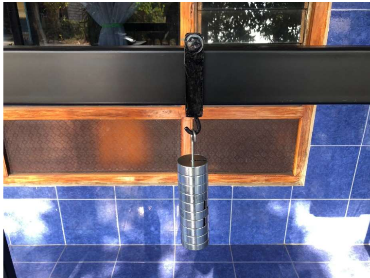
Gambar L-2. 11 Letakkan Beban Gantung Pada Penggantung Beban
