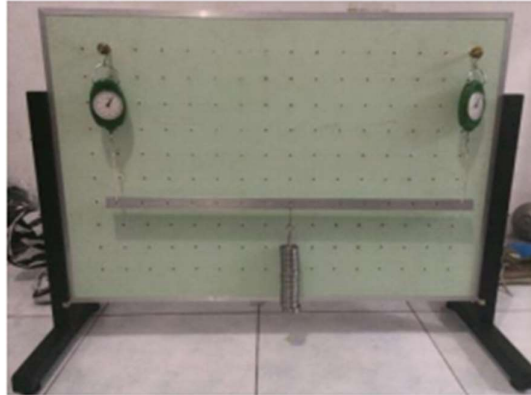
Gambar 2. 3 Alat peraga keseimbangan balok
