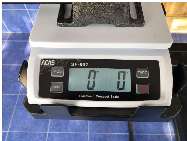
Gambar L-2. 10 Hidupkan Timbangan, Klik Tombol “Tare” Pada Timbangan
