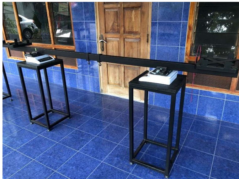
Gambar L-2. 4 Letakkan Balok Utama Di Atas Ragum
