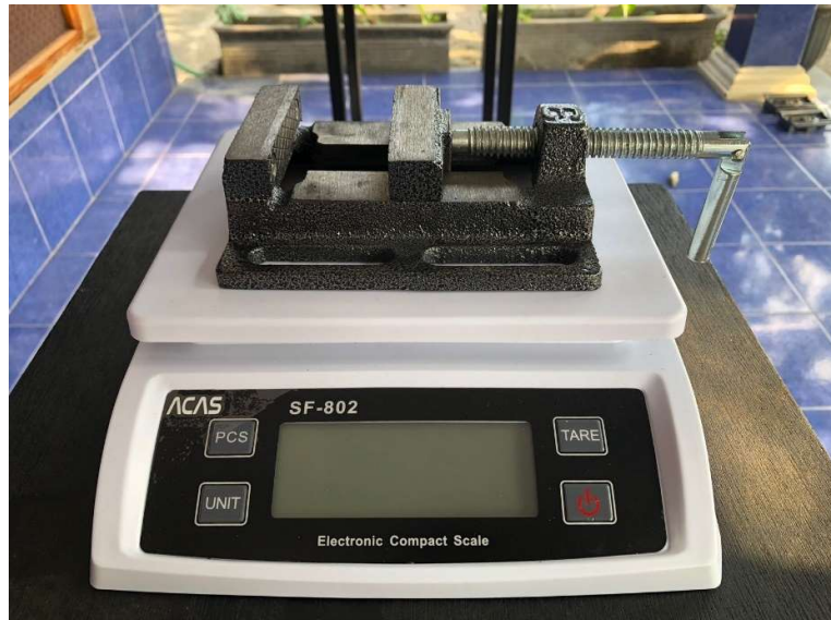
Gambar L-2. 3 Letakkan Ragum Di Atas Timbangan Digital
