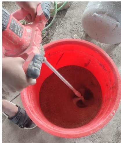
Gambar L 4. 5 Pengadukan campuran pasir, semen, CKS, & silica fume
