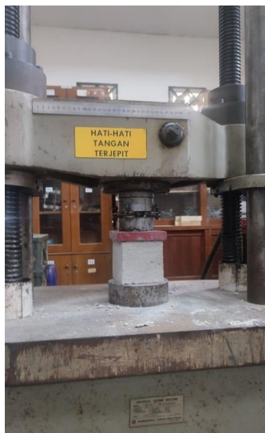
Gambar 5. 10 Pengujian Kuat Tekan Bata Ringan
