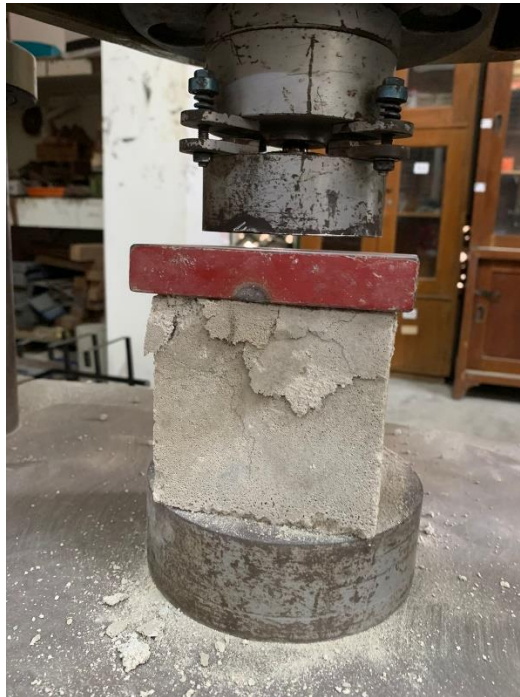
Gambar L 5. 8 Pengujian Kuat Tekan Bata Ringan Hingga Kuat Tekan Maksimum
