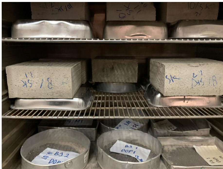
Gambar 5. 4 Bata Ringan Dikeringkan Didalam Oven
