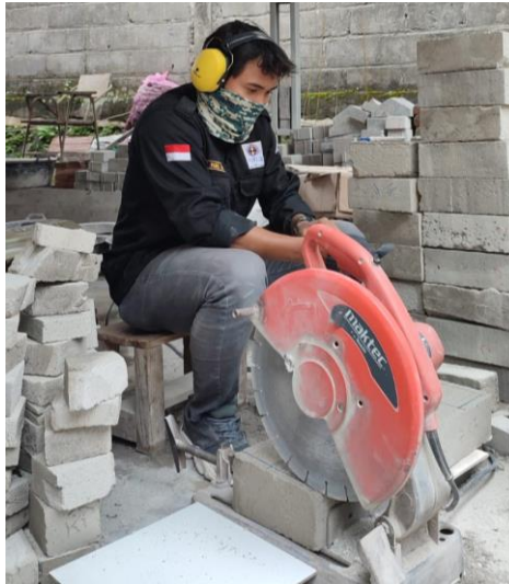
Gambar L 5. 2 Pemotongan Benda Uji
