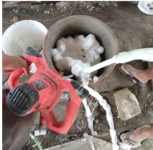
Gambar L 4. 7 Busa Dimasukkan Kedalam Campuran Pasta Bata Ringan
