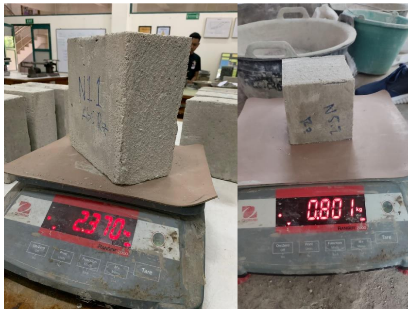
Gambar L 5. 3 Proses Penimbangan Benda Uji
