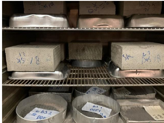
Gambar L 5. 4 Proses Pengeringan Benda Uji Dengan Oven
