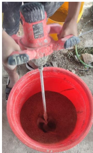
Gambar L 4. 6 Pengadukan Campuran Pasta Bata Ringan
