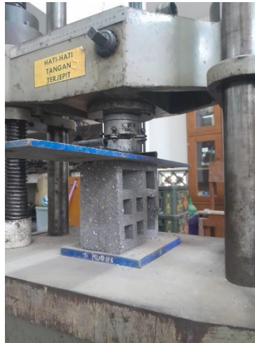
Gambar 4. 5 Proses Pengujian Kuat Tekan
