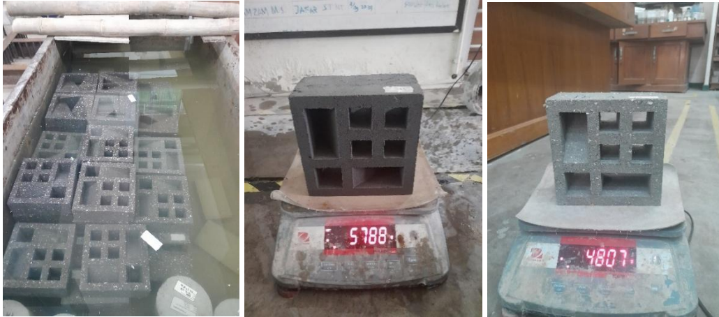
Gambar 4. 7 Proses Pengujian Daya Serap Air
