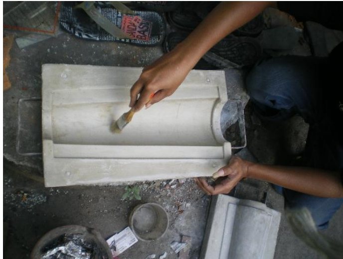
Gambar 3-7 Proses Pembersihan Cetakan Menggunakan Kuas
