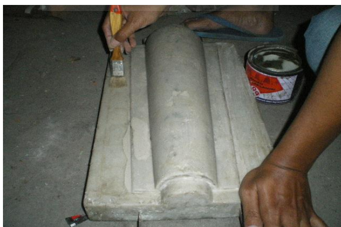
Gambar 3-11 Proses Pengolesan M.A.A Pada Cetakan.
