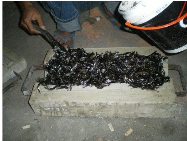
Gambar 3-14 Proses Penuangan Bulu Ayam Kedalam Cetakan.
