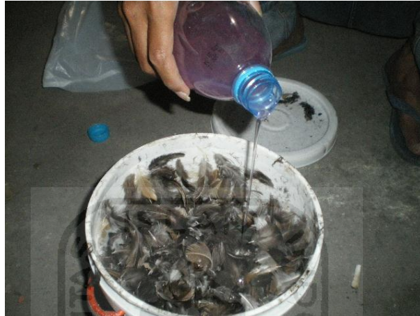
Gambar 3-12 Proses Penuangan Resin Pada Bulu Ayam.
