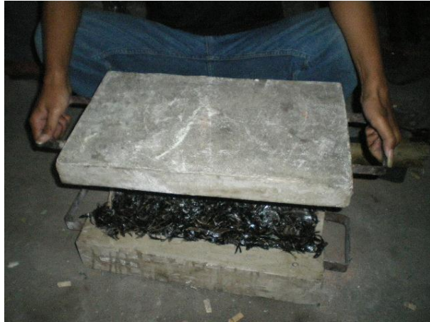
Gambar 3-16 Menutup Cetakan Model Cup dan Drag .
