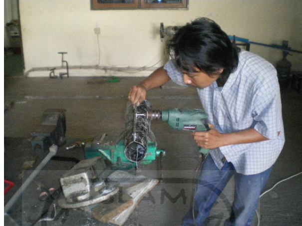
Gambar 3-21 Melubangi Sisi Produk Dengan Bor Tangan.
