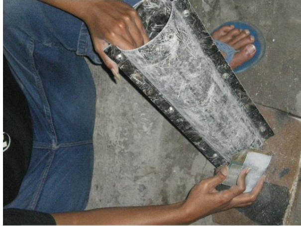
Gambar 3-23 Proses Ampelas Bagian Depan dan Belakang.
