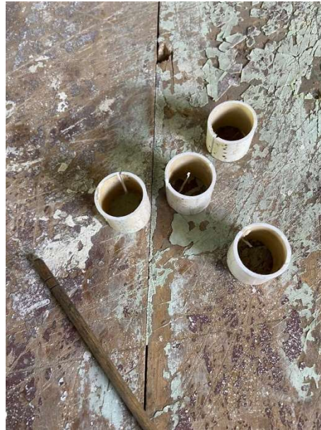
Gambar L-1.3 Pembuatan Cetakan Untuk Benda Uji Penyerapan, Kerapatan dan Volume Rongga Udara
