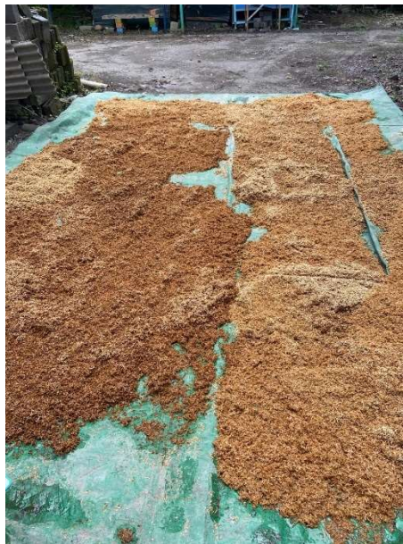
Gambar L-1.2 Pengeringan Sekam Padi Sampai Kondisi SSD
