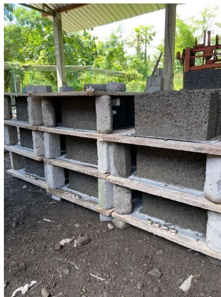
Gambar L-1.8 Penyimpanan Batako Setelah Dicetak
