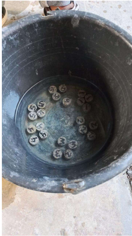
Gambar L-2.5 Perendaman Benda Uji
