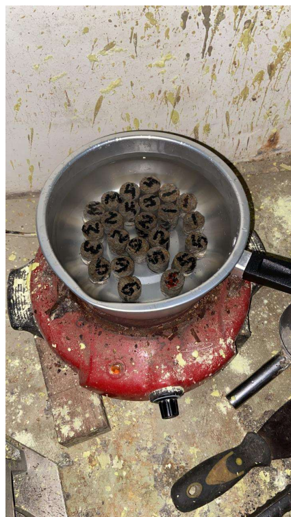
Gambar L-2.6 Pendidihan Benda Uji
