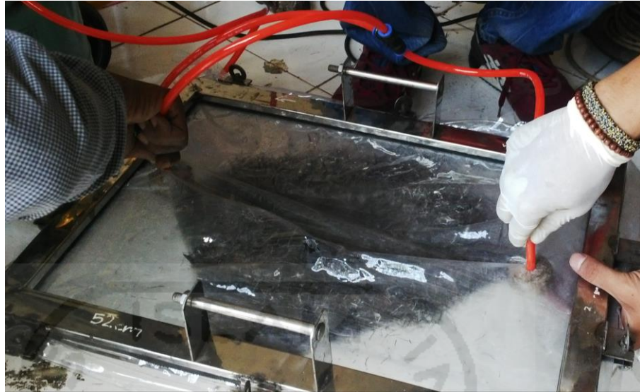
Gambar 4.18 Proses Pengecekan Kebocoran Pada Pemvakuman Cetakan.
