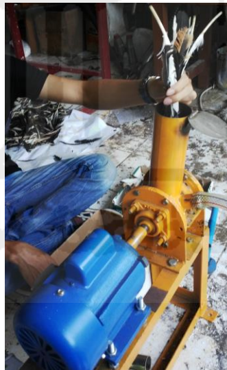
Gambar 4.3 Proses Pengolahan Bulu Ayam Dengan Sistem Crusher (Pencacah).
