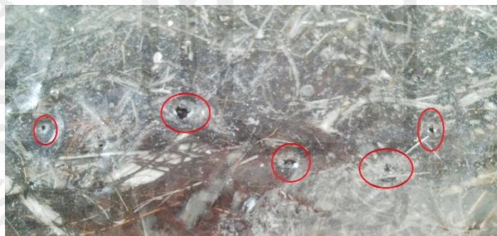
Gambar 4.23 Terdapat Void pada Produk Komposit.
