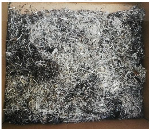
Gambar 4.27 Hasil Bulu Ayam Menggunakan Alat Pencacah.
