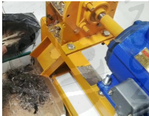
Gambar 4.4 Hasil Bulu Ayam Yang Diolah Menggunakan Alat Dengan Sistem Crusher (Pencacah).
