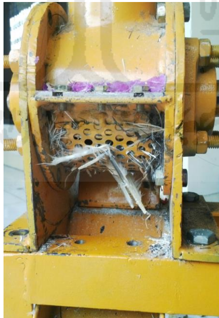
Gambar 4.7 Bulu yang Tersangkut pada Plat Strimin.
