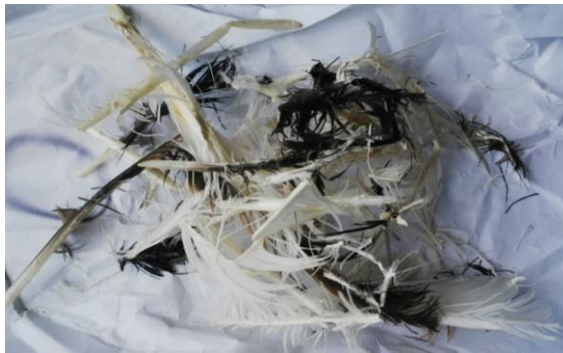
Gambar 4.8 Bulu yang Tidak Tercacah di Tabung Pencacahan dan Tersangkut di Plat Strimin.
