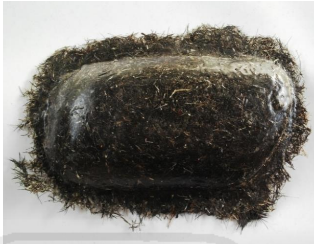
Gambar 4.22 Produk Komposit Menggunakan Bahan Bulu Ayam.
