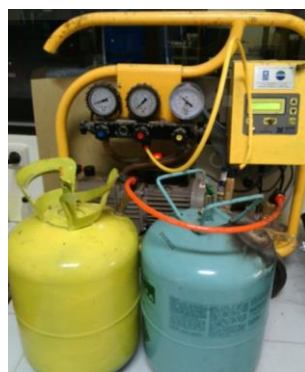
Gambar 4.9 Selang Tabung dan Pompa Vakum Telah Terpasang.
