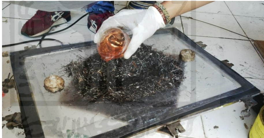
Gambar 4.19 Penuangan Resin yang Telah Dicampur dengan Katalis ke Dalam Cetakan.
