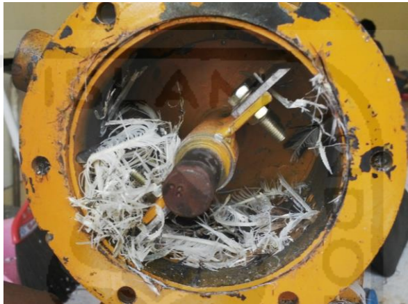
Gambar 4.6 Bulu yang Tidak Tercacah Sempurna yang Berada di Dalam Tabung Pencacahan.
