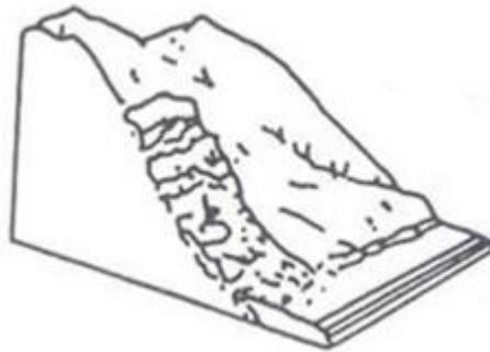
Gambar 3.4 Gerakan Tanah Jenis Longsoran Translasi
