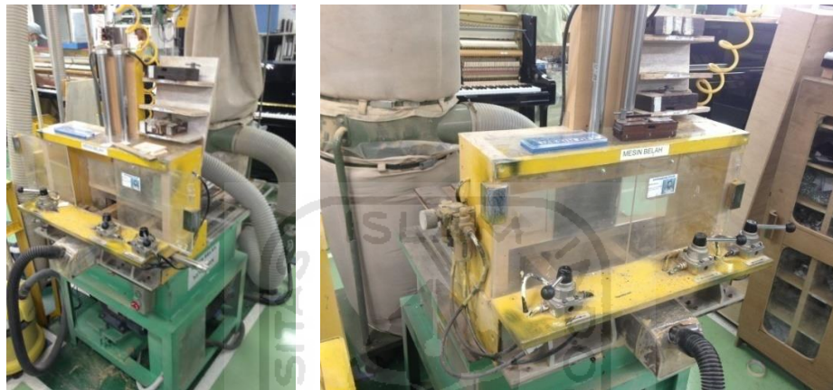
Gambar 3.6 Mesin belah keyblock di PT. Yamaha Indonesia
